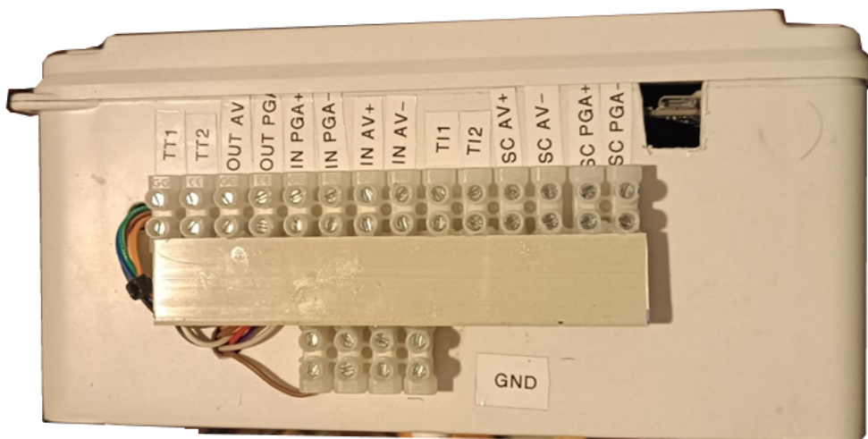
Figura B.1: Lateral de la caja EDM con las entradas y salidas
