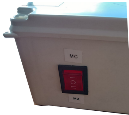
Figura B.2: Llave de 3 posiciones con modos MA, OFF, MC
