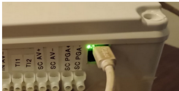
Figura B.4: Conexión USB con Arduino desde el exterior de la caja
