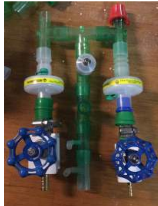
Tramo del circuito destinado a la mezcla de gases en su configuración más compacta lograda
