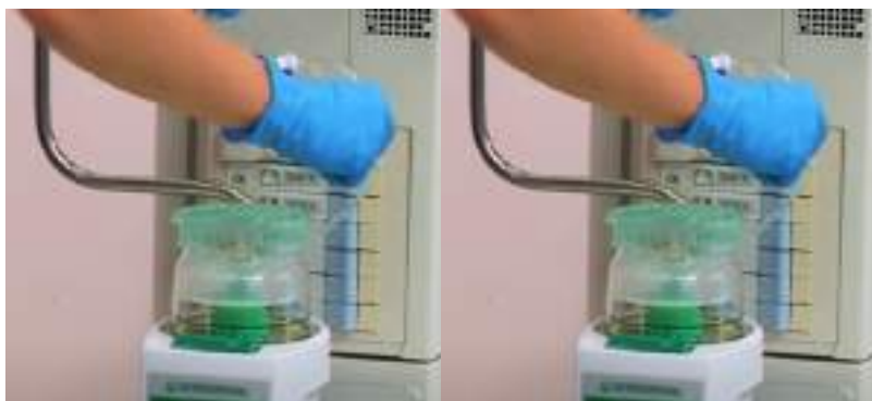
Colocación de ingreso de agua al humidificador
