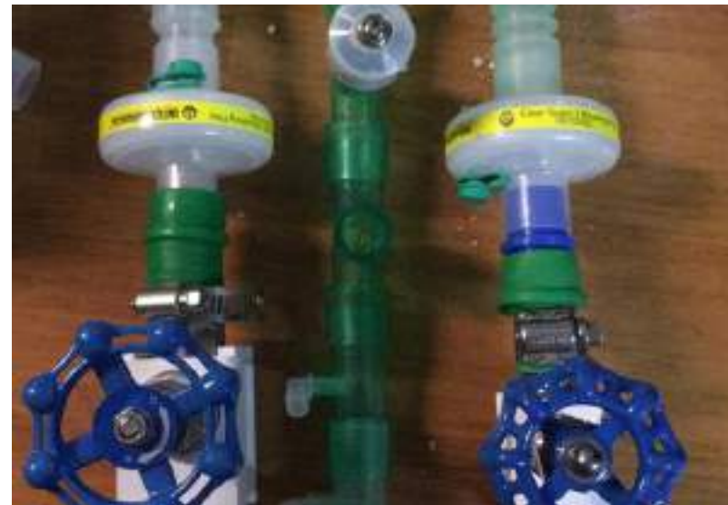
Luego de las válvulas se aprecian los filtros de aire que al retirarse, permitió reducir el tamaño del mezclador.
