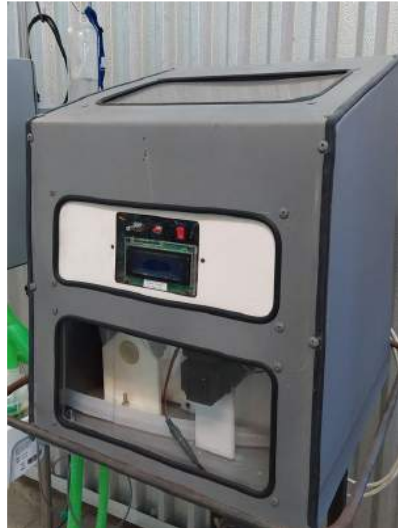
Imágenes del respirador después de ser reconfigurado y dispuesto en su envoltorio
