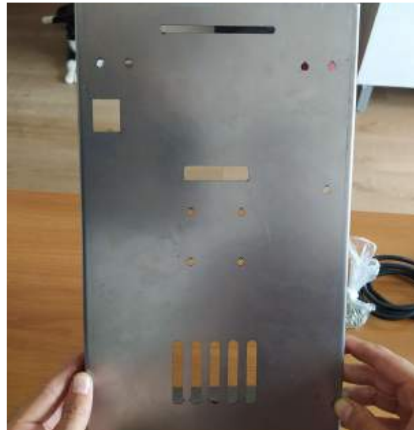
Vista de la cara posterior de la envolvente metálica cortada y plegada CNC.
