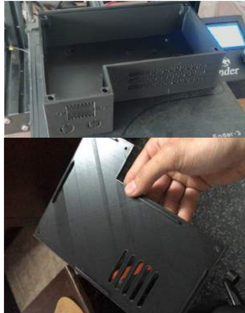
Nueva caja electrónica impresa 3D tanto su cuerpo como su tapa
