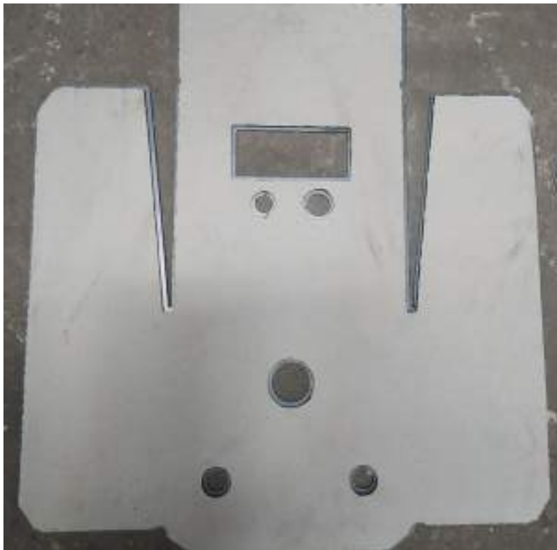
Plantilla impresa láser que se utilizó como guía de corte para cortadora plasma manual
