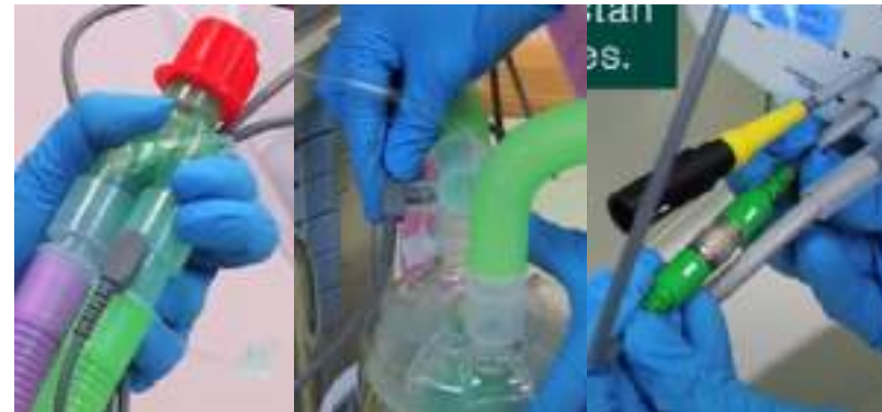
Conexión de sonda de temperatura al cable del humidificador
