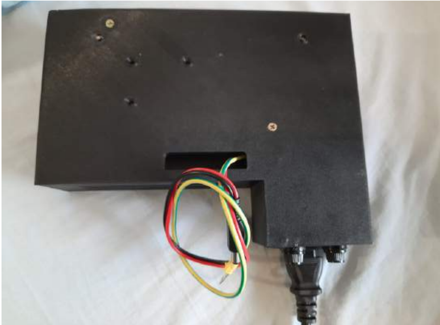
Vista posterior de la caja electrónica con su respectivo cableado realizado por un miembro del equipo de Ingenieros de Fing
