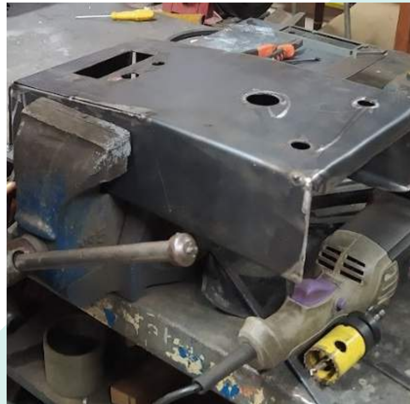
Resultado del corte y plegado manual de uno del primero prototipo del OAF
