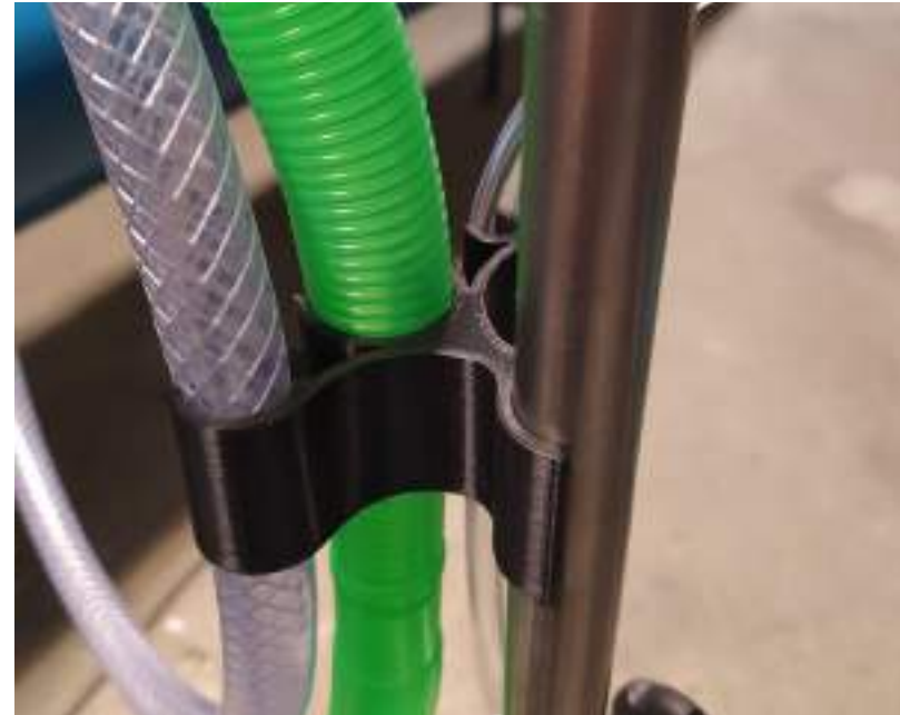
Acercamiento a la unión al atril aprovechando flexibilidad del PLA de las impresiones 3D.
