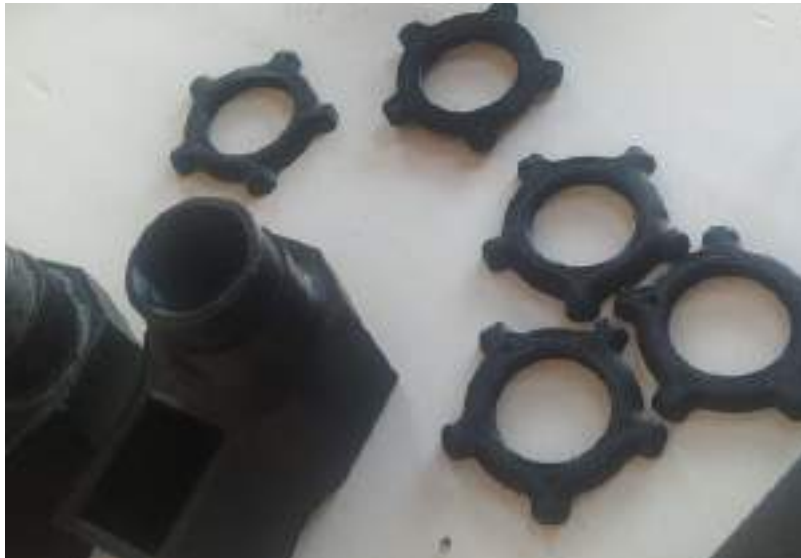
Primeras pruebas impresas 3D del agarre de tipo rosca
