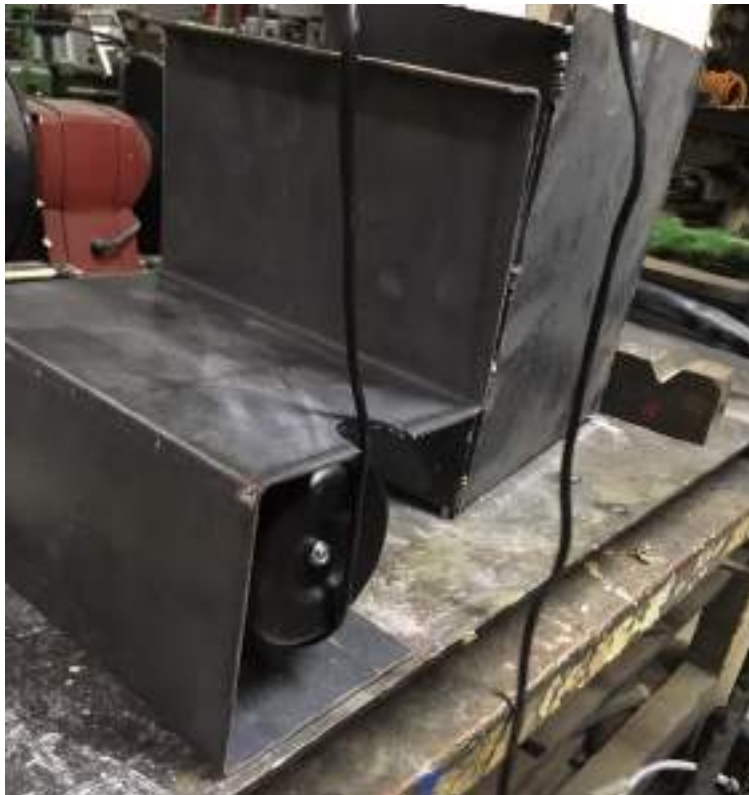
Soporte en forma de "S" para los compresores con uno de ellos instalados debajo. El restante se coloraría arriba.
