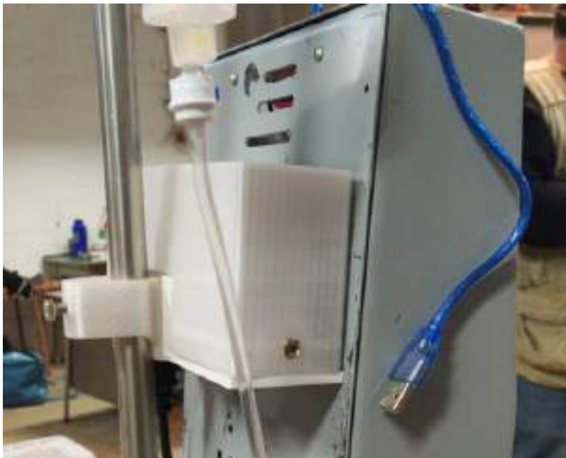
Una de las primeras pruebas de la caja eléctrica impresa utilizando PETG.
