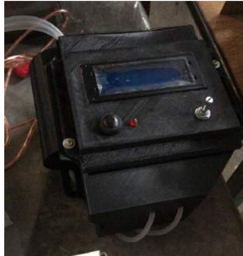
Carcasa de electrónica, con su tapa colocada y sus componentes instalados.
