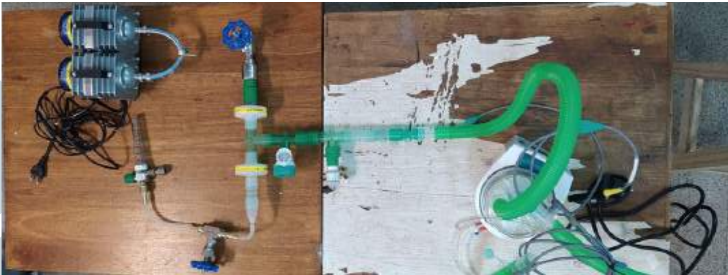
Primer modelo funcional basado en el diagrama de circuito elemental de gases y fluidos
