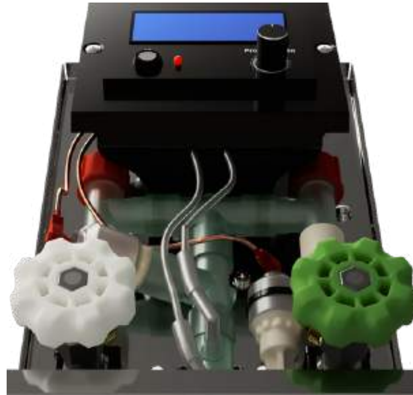
Disposición los tubos internos y externos a la caja de electrónica.
