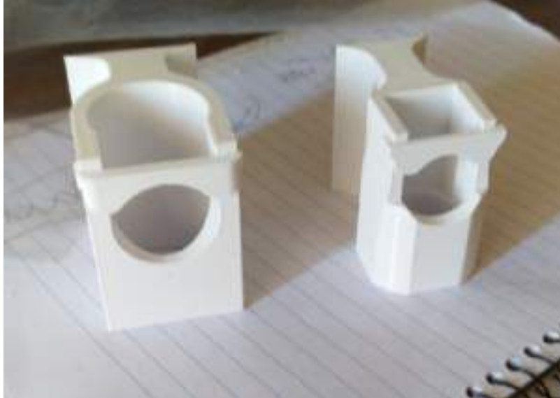
Propuesta de soporte para sujetar las válvulas genebre al cuerpo de la envolvente metálica
