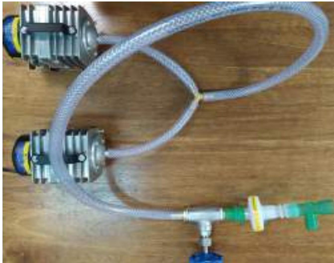
Compresores de aire conectados al mezclador de gases en sus primeras etapas
