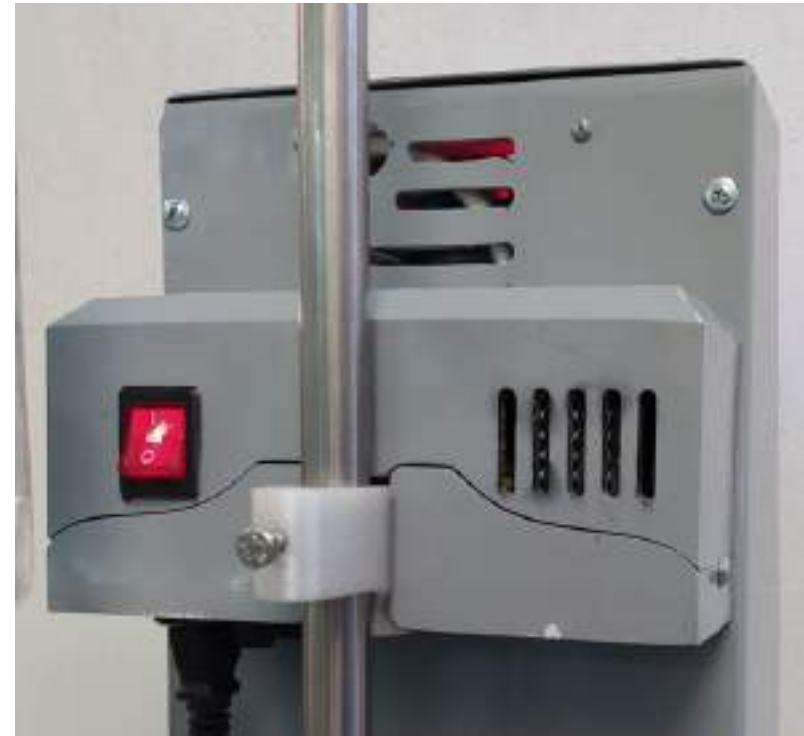
Vista posterior del prototipo 1 con su carcasa del circuito eléctrico y el soporte al atril ya instalados.
