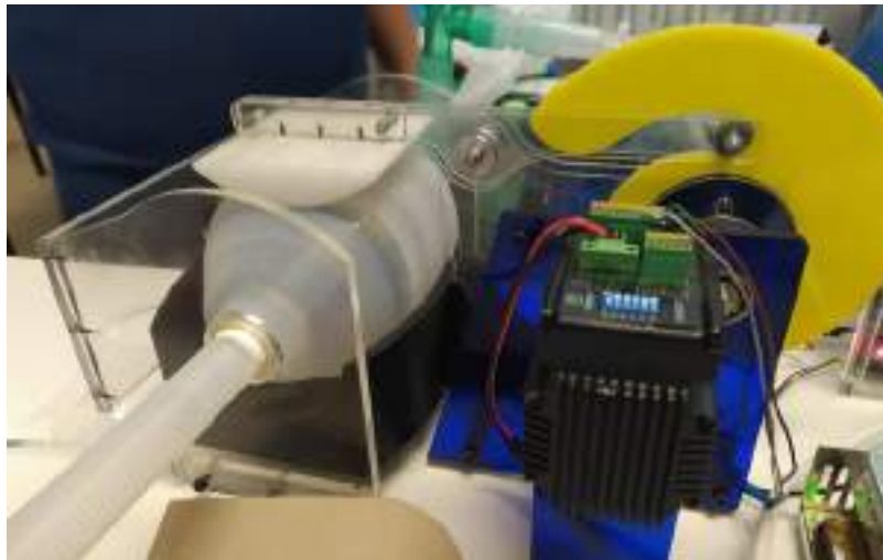
Fotografía del conjunto interno del respirador mecánico previo a los cambios propuestos por la EUCD.
