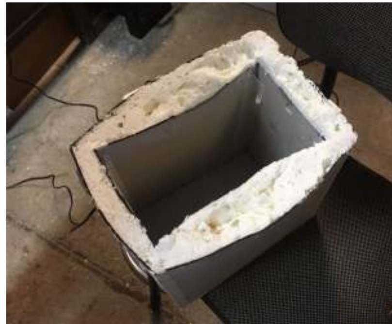
Pruebas con poliuretano expandido dentro de una estructura de cartón, para medir ruidos.
