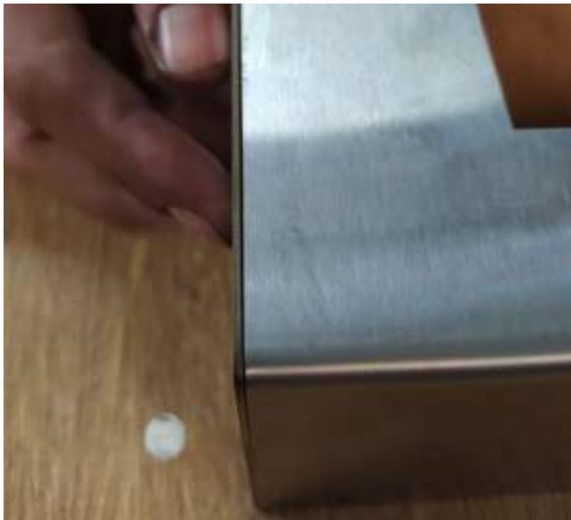
Acercamiento a tolerancias de pliegue luego de corte por chorro de agua y plegado CNC.
