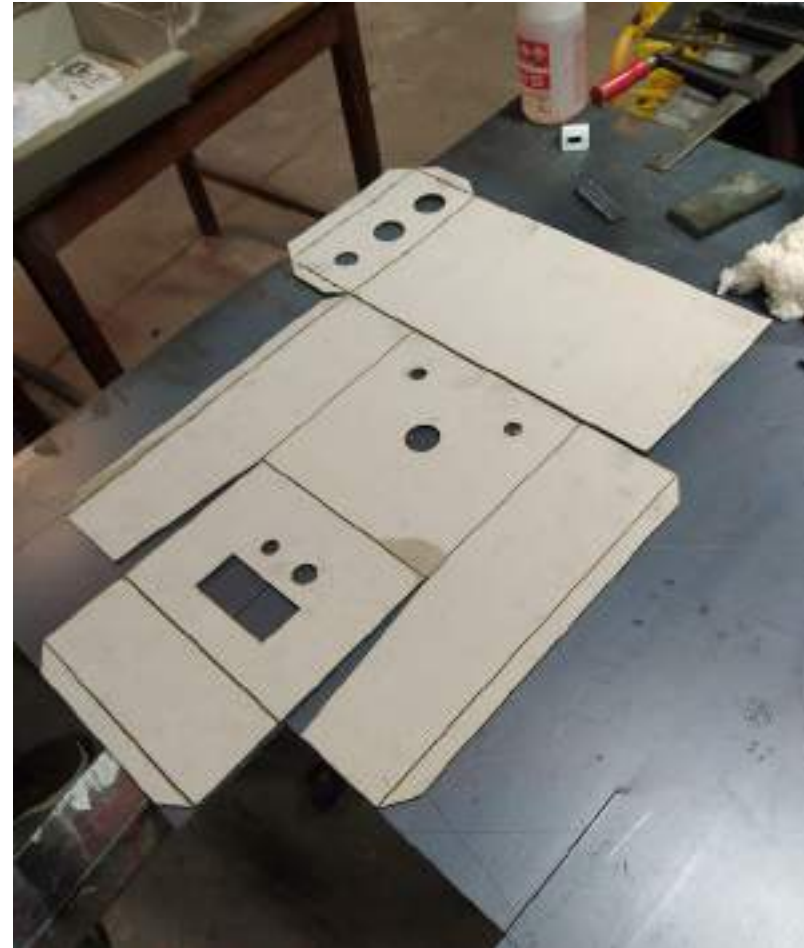
Plantillas de cartón cortadas láser para utilizarlas de guía para corte plasma manual
