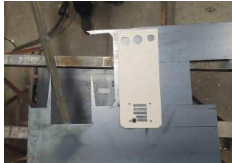
Corte plasma manual utilizando matrices de cartón.
