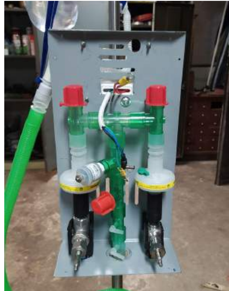
Vista del interior de la primer versión del prototipo final dónde se puede apreciar el sistema de mezcla de gases
