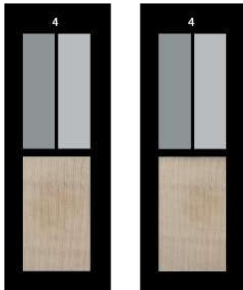
**Figura 20.** Prueba de solidez al frote en húmedo. *Ulva* spp., teñido en frío y ácido cítrico (izquierda) y *Grateloupia turuturu*, teñido en frío y sulfato ferroso (derecha)
