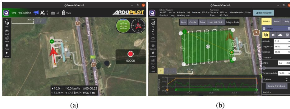
Figura 3.7: Interfaz gráfica de la estación de control QGroundControl . En 3.7a se muestra su funcionamiento de control manual, en el cual se pueden controlar parámetros de vuelo como altura y destino. En 3.7b se muestra la herramienta de creación de planes de vuelo autónomo.
