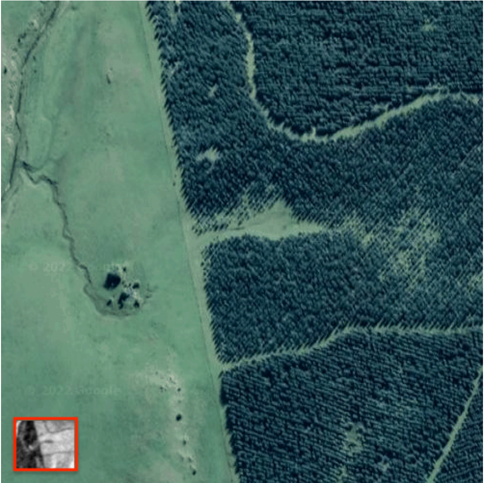
Figura 5.1: Imágenes obtenidas de Google Earth Engine mediante ros_georegistration . Se puede ver información de cámaras RGB y NIR (en el recuadro rojo) centradas en la posición de comienzo del dron simulado, y de 500m de lado. Si bien la dimensión utilizada es la misma, la resolución de los datos es 10 veces menor en la imagen NIR (no se alteró el tamaño de las imágenes).
