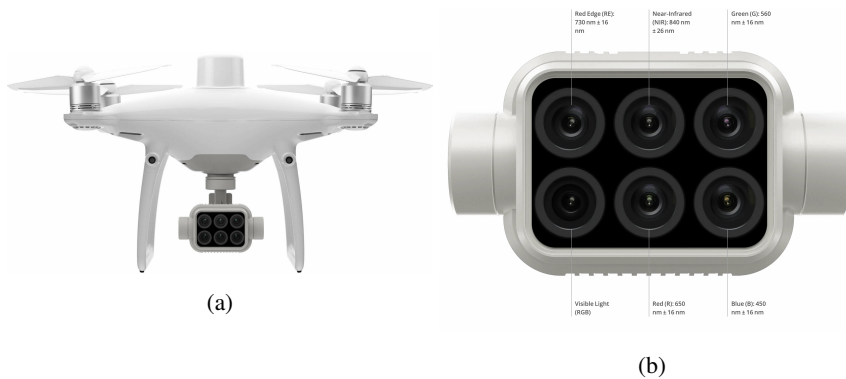
Figura 3.4: En 3.4a se puede ver un ejemplo de dron con soporte a captura de imágenes multispectrales: el DJI P4 Multispectral . En 3.4b se muestra la cámara multispectral en mayor detalle, describiendo las bandas de luz y los rangos en los que captura imágenes.
