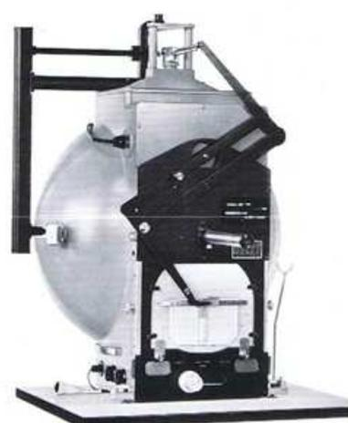
Fig. 4: Perimeter für statische Perimetrie
