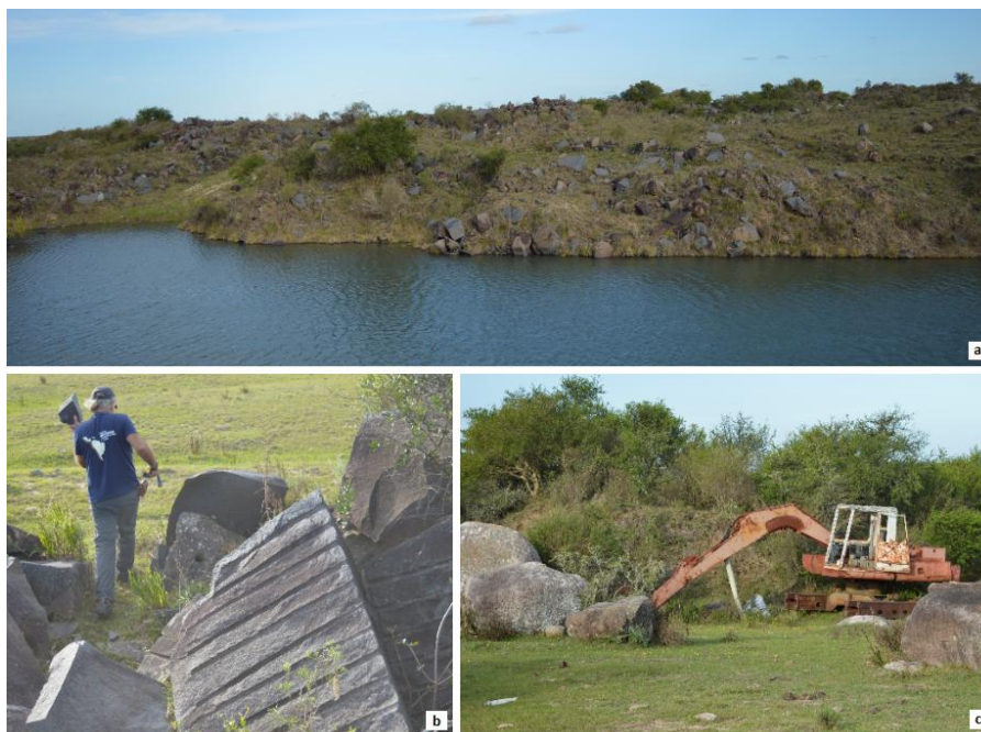
Fig. 22. Cantera de “granito negro” abandonada: a) open pit y escombreras; b) detalle de escombrera, se aprecian marcas de los barrenos en los bloques; c) maquinaria de obra abandonada en el predio.
