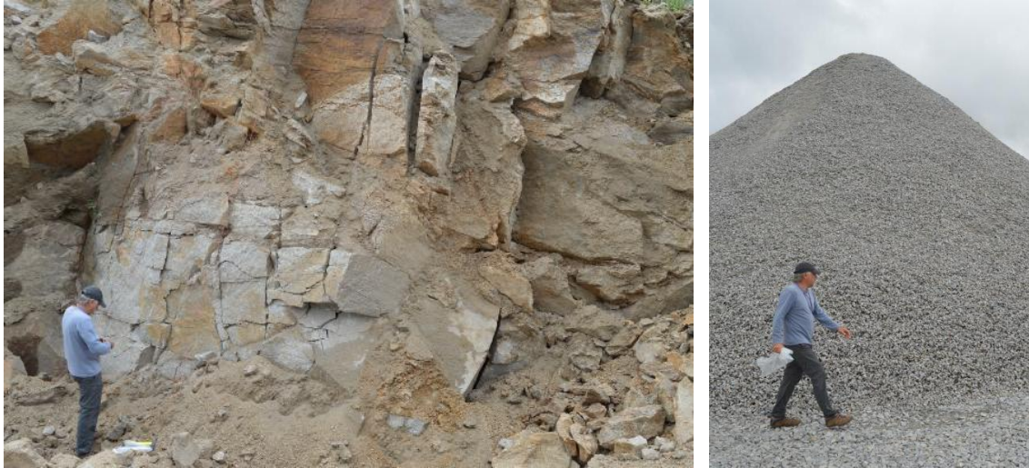
Fig. 32. Explotación de granito para piedra partida: a la izquierda , frente de extracción; a la derecha , acopio de piedra partida pronta para despachar.
