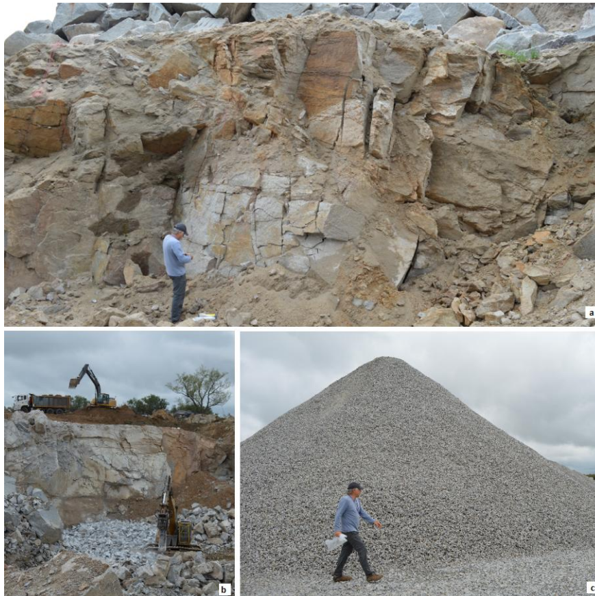
Fig. 24. Cantera de granito gris (para producción de piedra partida) en operación: a) frente de cantera; b) actividades en la cantera arriba destape de material estéril, abajo achique de bloques con martillo neumático; c) acopio de piedra partida pronta para salir del predio.
