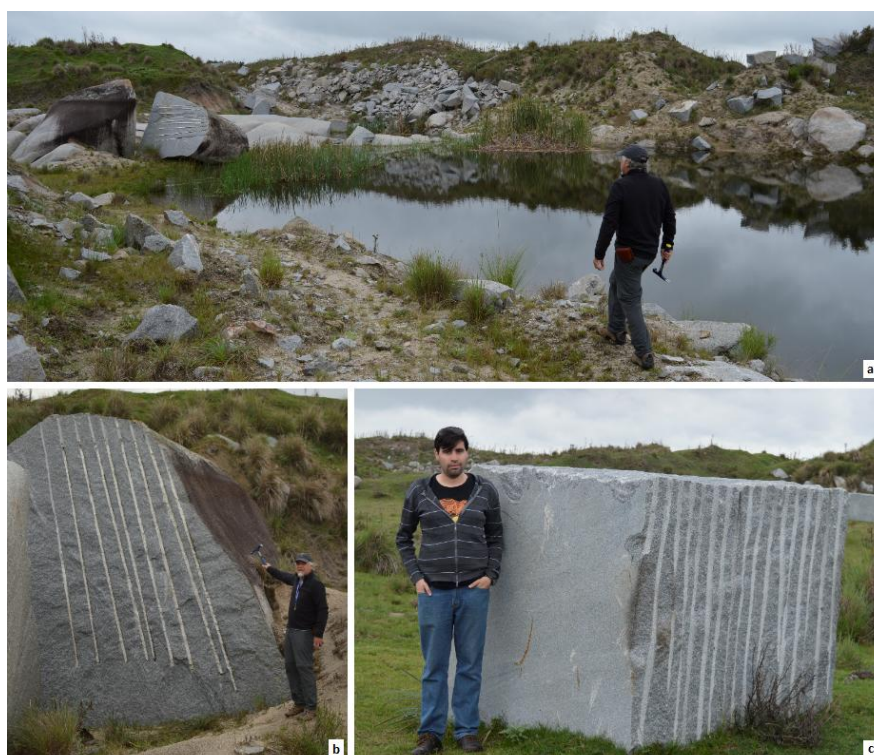
Fig. 23. Cantera de granito gris (con fines ornamentales) abandonada (actualmente en trámite de autorización para re iniciar actividades): a) open pit y escombreras; b) bocha barrenada; c) bloque de granito de 1,5 m de lado pronto para retirar del predio.
