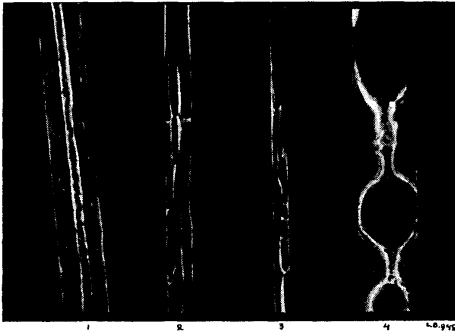
Fig. N.º 8. — 1) Fibra vegetal invadida por un micelium. Destrucción de la secundaria y conservación de las capas primaria y terciaria de la pared. — 2) Formación cavitaria cónica y bicónica enzimática; completa disolución de la pared secundaria. La primaria se conserva intacta. En la terciaria se inicia la desintegración. — 3) El avance de la hifa se realiza por el centro. — 4) Cavidad enzimática; nótese la doble refracción. — Material de fecas de equino estudiado a la luz polarizada (x 400). Ataque de las paredes celulósicas por hongos y actinomicetes, dibujo de una fotografía de Baker (1939).
