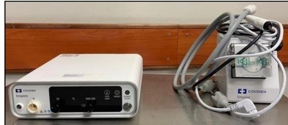
**Fig 1. Equipo de microondas, base y antena.**
