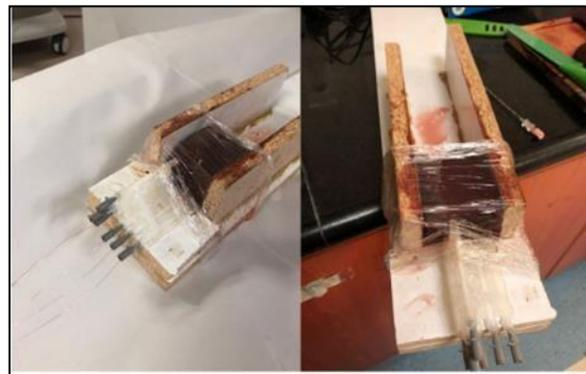
**Fig 3. Modelo experimental constituido por madera e hígado con antena de MO y filamentos correspondientes al**
