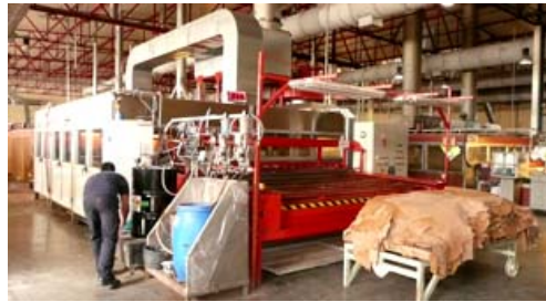
Túnel de Napalizado
