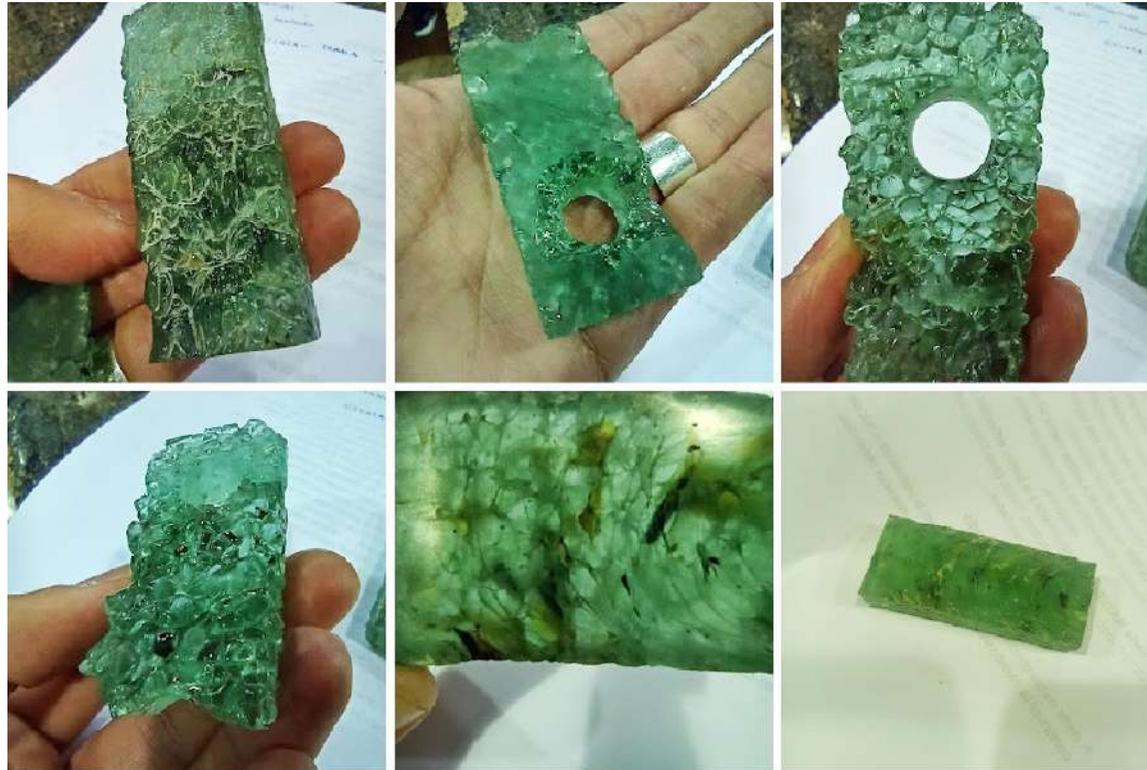
Imagen 18: Pruebas de horneado con distintas curvas de temperatura en el LaV - Fuente: Autoria propia.
