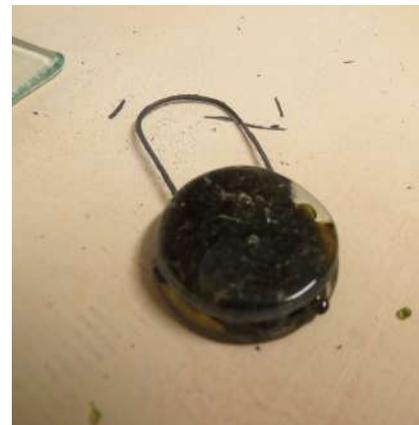
Imagen 12 - Pieza doble de vidrio con molienda entre capas y pasante metálico fijo sin hornear / Imagen 13 - Misma pieza luego de ser horneada Fuente: propia
