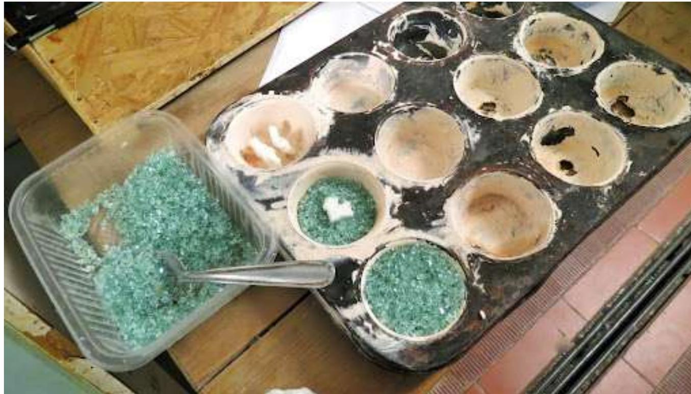
Imagen 24 - Ensayo con vidrio templado automotriz y manta cerámica - Fuente: propia
