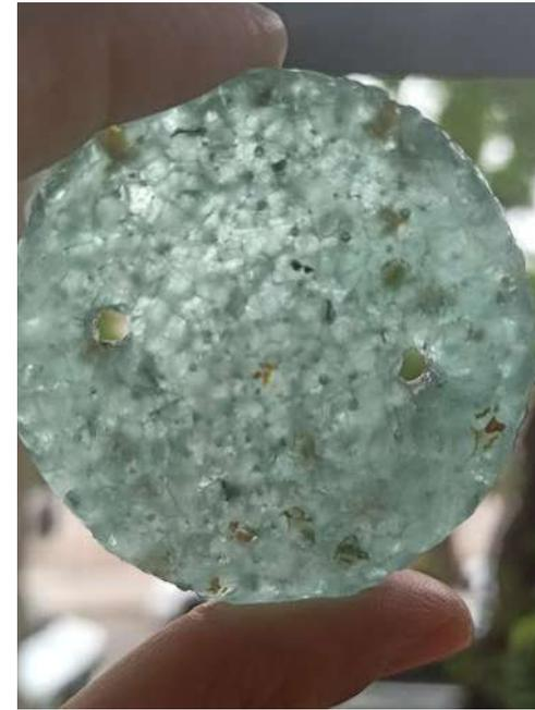
Imagen 39 - Módulos de vidrio templado automotriz reutilizado / Imagen 40 - Textura visual del módulo obtenido. Fuente: propia
