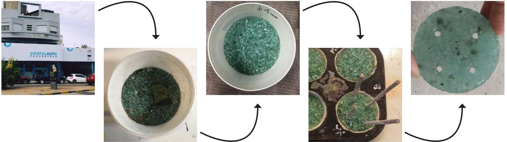
Imagen 41: Esquema de proceso de reciclado simplificado del vidrio templado automotriz Fuente: Autoría propia.
