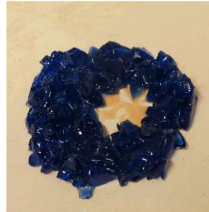
imagen 8 - Mezcla silicona líquida con molienda de vidrio azul /Imagen 9 - Disposición de la mezcla sobre la base del horno - Fuente: propia
