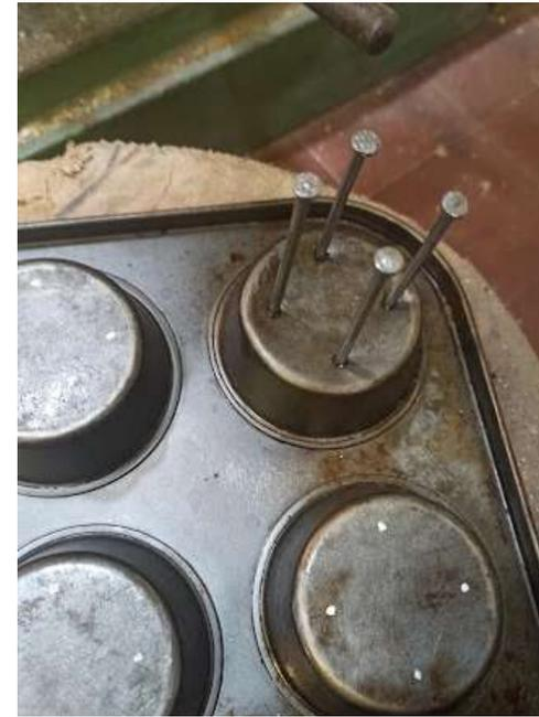
Imagen 33 - Molde de repostería siendo perforado en su base / Imagen 34 - Molde de repostería con clavos pasantes. Fuente: propia
