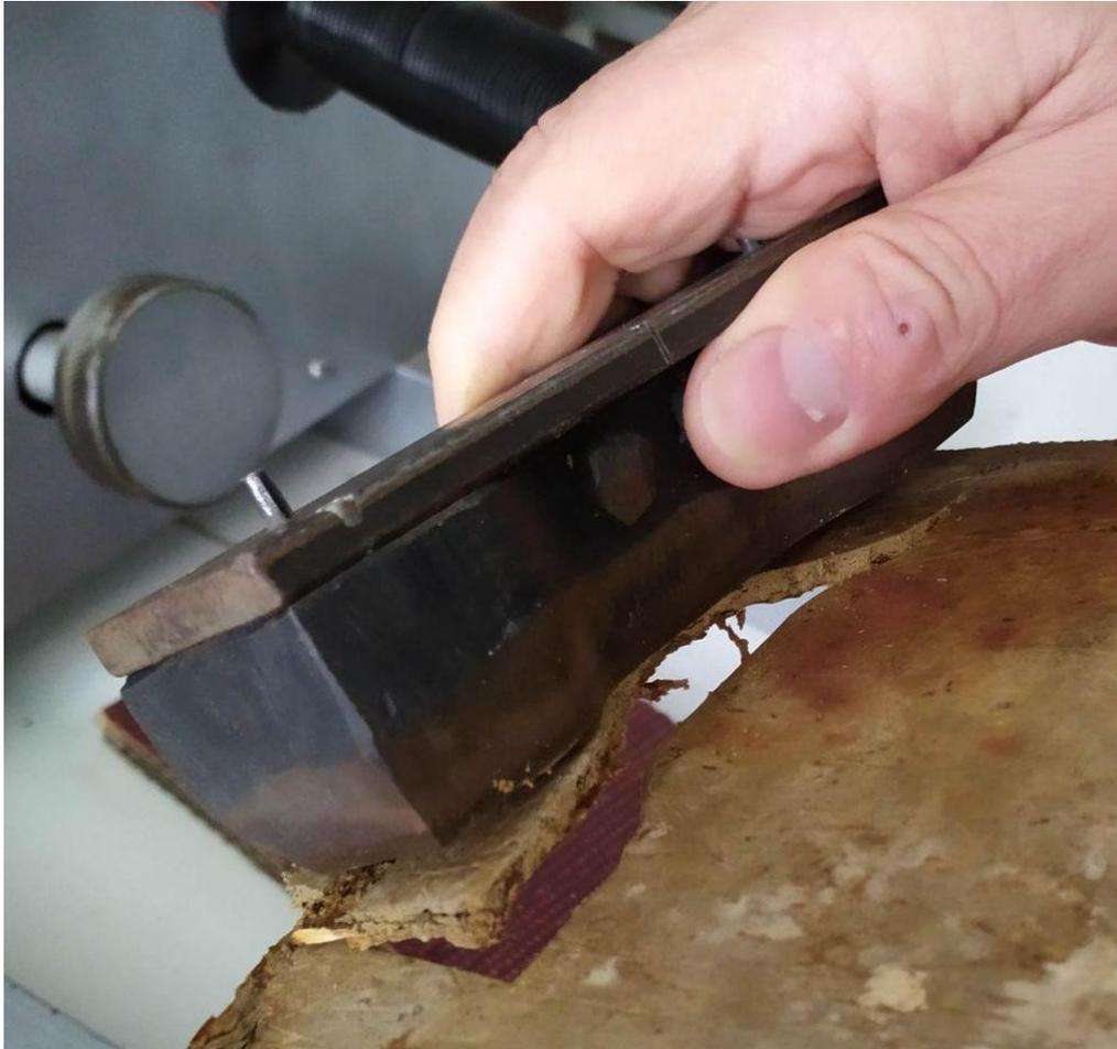
**Imagen 31: Análisis de Tensión: Corte de probeta con sacabocado
