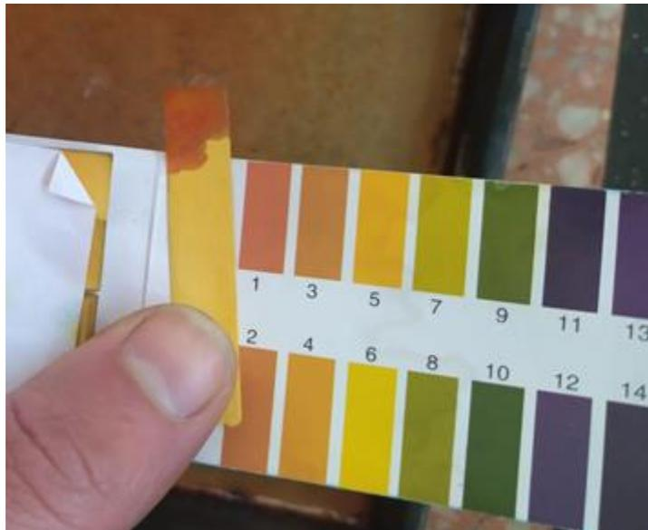
**Imagen 20: Medición del PH en muestra Blanca**
