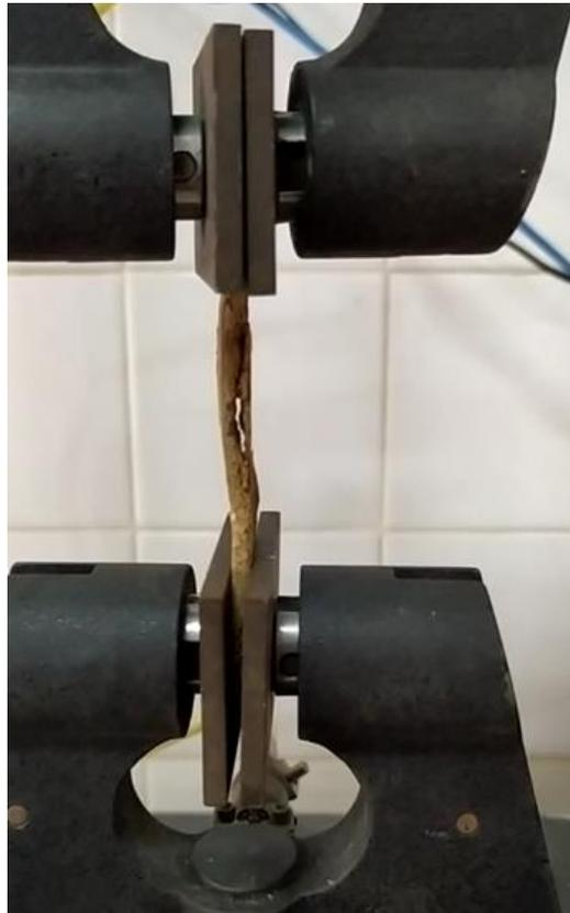
**Imagen 23: Probeta en ensayo de Tensión**
