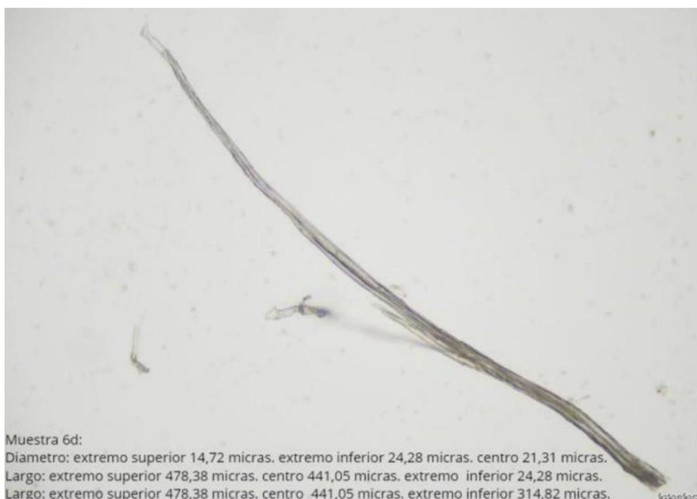
**Imagen 16: Microscopía óptica de fibra del residuo de cañamo**
