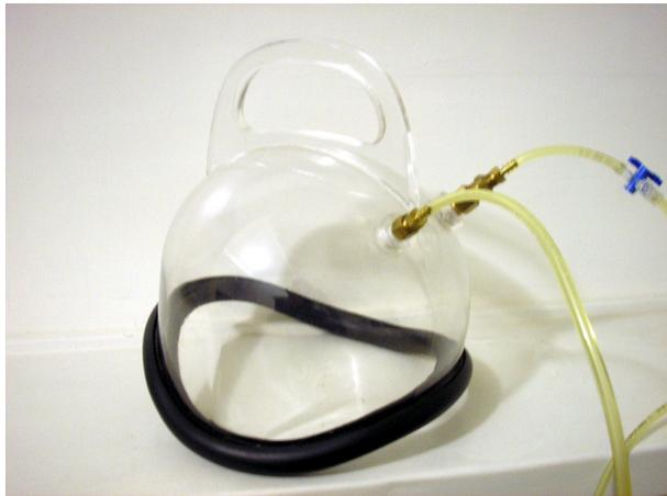
Fig. 2: Fotografía de la campana de ABDOPRE. Notar los tubos que la conectan al transductor y a la bomba de vacío.
