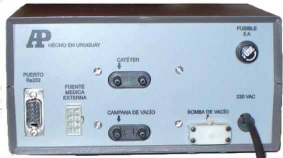
Fig. 3: Vista posterior del prototipo de ABDOPRE. Notar las conexiones para el catéter, la bomba y la campana. A la izquierda se conecta al computador.
