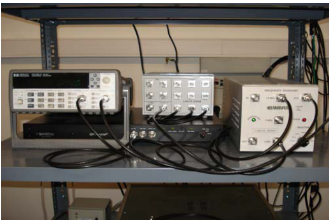
Fig. 4. Foto del equipamiento que compone el patrón de frecuencia.
