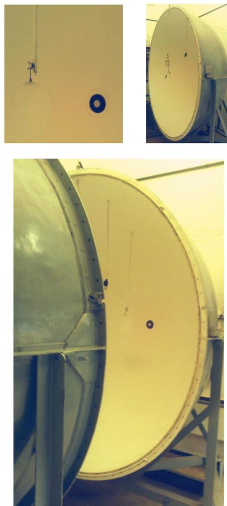
Figura 1: Esfera de Ulbricht del LabFot-IIE.
