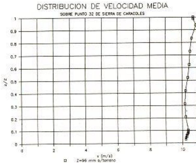
Figura 5 – Distribución de velocidad en altura sobre el Cerro de los Caracoles
