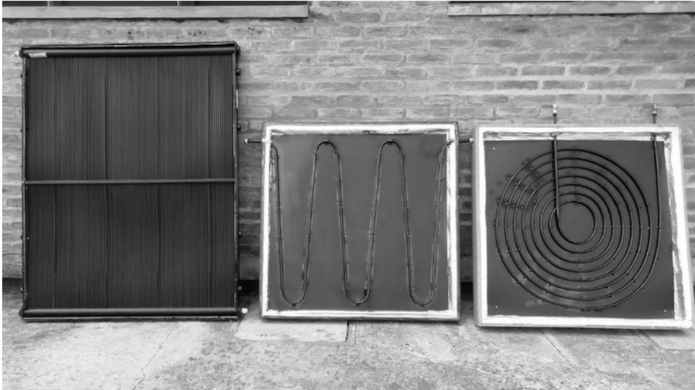
Figura 1- Fotografía de la placa colector de los tres colectores FPC1, FPC2 y FPC3 de izquierda a derecha.
