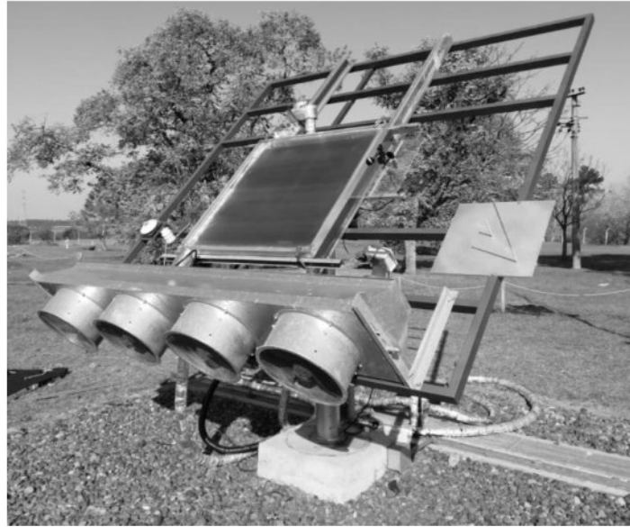
Figura 2- Montaje del colector FPC2 en el seguidor solar.
