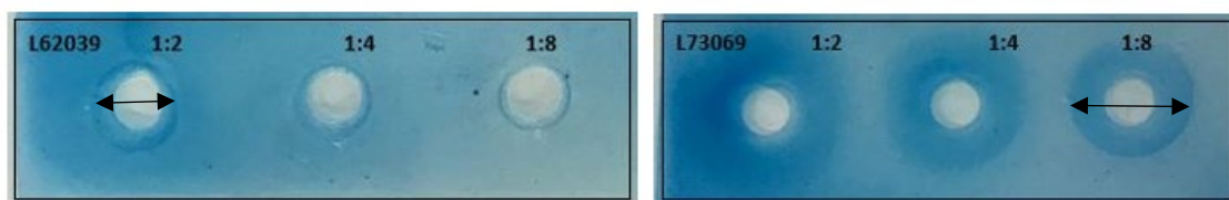
Fig. 8. Se presentan dos trozos de gel ya teñidos, donde se puede observar la necesidad de sembrar la muestra problema a diferentes concentraciones a modo de screening. En el primer gel se observa como una dilución al medio en el primero hoyo permite una medición correcta del halo, mientras que, en el segundo gel, recién con una dilución 1:8 se observa un halo correctamente definido para ser medido.
