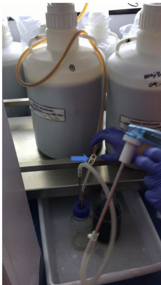
Fig. 19. Tubuladura de muestreo aséptico para balones de pasaje R3. Sobre botella schott se genera vacío utilizando pipeteador automático, una vez colectada la muestra, para evitar la recirculación de solución hacía zona aséptica de la tubuladura, se interrumpe el flujo con la llave indicada con flecha azul.
