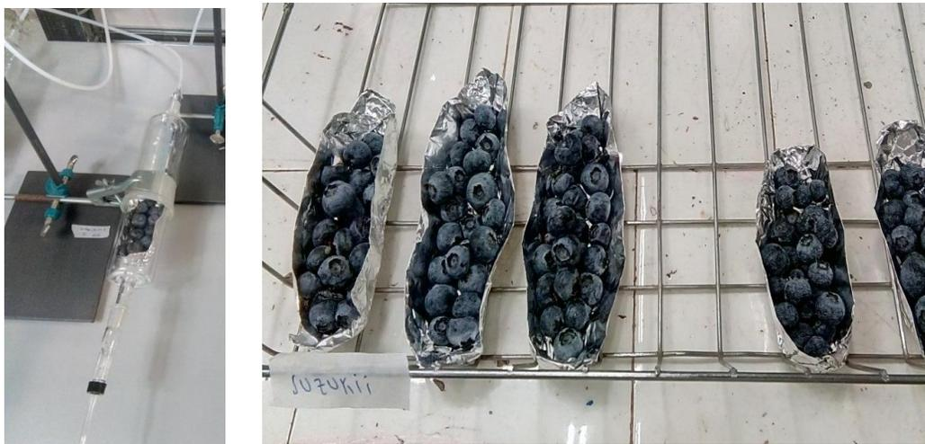
Figura 5. (izq) Vista en detalle del sistema utilizado para la captura de compuestos orgánicos volátiles. (der) Arándanos dispuestos sobre papel de aluminio para muestreos de compuestos volátiles.
