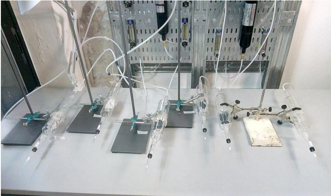
Figura 4. Sistema utilizado para la captura de compuestos orgánicos volátiles.
