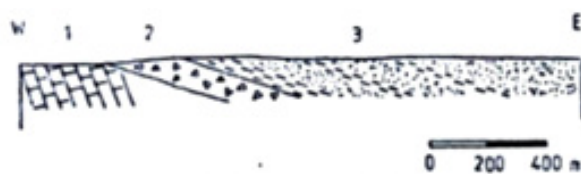
Figura F.1.2 - Corte de la formación Barriga Negra en los alrededores del Arroyo Malo 1- rocas calcáreas metamórficas 2- brechas con elementos carbonáticos. 3 - Areniscas feldespáticas y arcosas con intercalaciones de pelitas violetas. 2 y 3 corresponden a la Formación Barriga Negra. Notese la discordancia angular esbozada entre las unidades 1 y 2. Tomado de Midot, 1984, p. 80.
