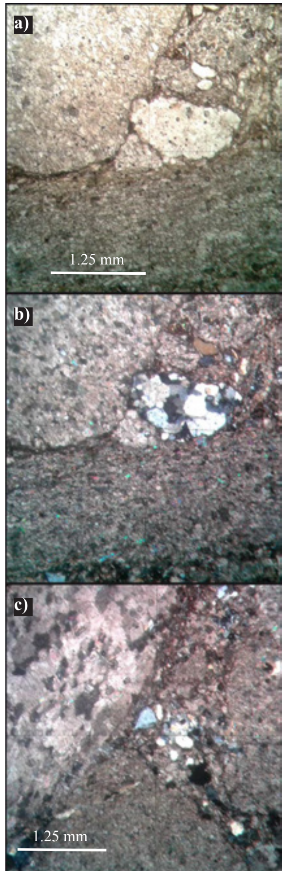
Figura F.4.11 - Corte petrográfico de la muestra , a: Luz normal b: Luz polarizada, c: Luz polarizada. La escala en las imágenes equivale a 2.5mm.
