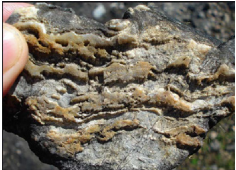
Figura C.3 - niveles de chert plegados y fracturados dentro de las rocas calcáreas.
