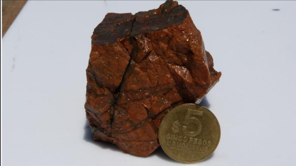
*Figura 6-2 Muestra de mano, roca félsica indiferenciada hidrotermalizada*
