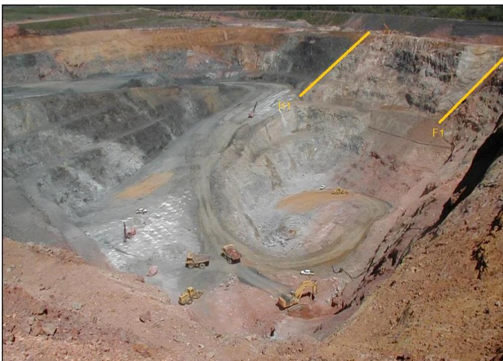
Figura 4-4 Vista desde el suroeste de la mina arenal donde se observan las fallas H1 y F1 |. 11
