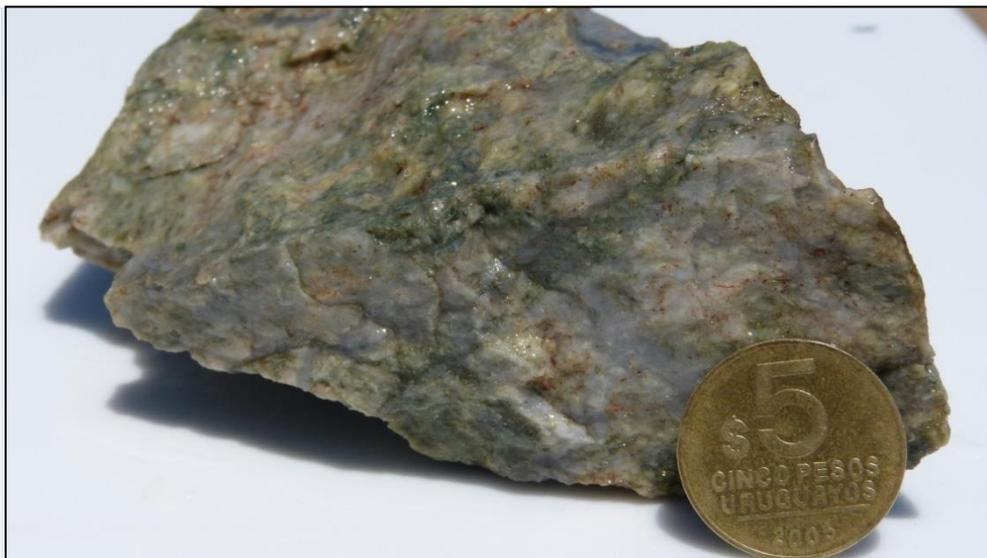
*Figura 6-3 Muestra de mano, brecha hidrotermal*
