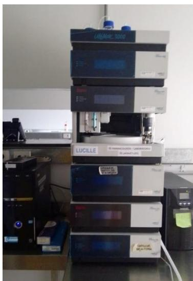
**Figura 10.** Cromatógrafo (HPLC Dionex, Ultimate 3000, con bomba LPG 3400 estándar, autosampler WPS 3000 PL, detector (DAD) 3000, loops de 50µl y de 250µl) para la realización de la técnica de Cromatografía líquida de alta resolución (HPLC: High Performance Liquid Chromatography), de la Unidad Académica de Farmacología, Departamento de Clínica y Hospital Veterinario, Facultad de Veterinaria, UdelaR.
