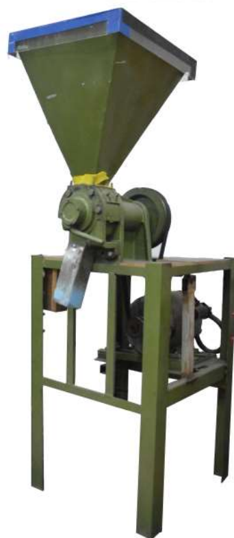
Trituradora tipo "molino" adquirida y adaptada por el taller.
