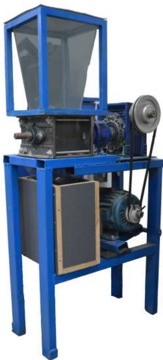
Trituradora tipo "shredder" basada en Precious Plastic v2.0
