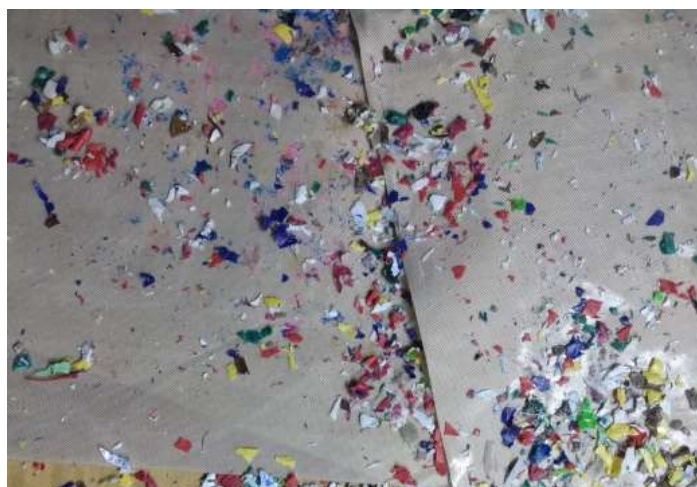
Material adherido por estática al teflón
