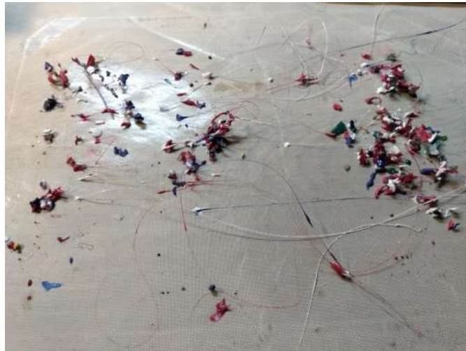
Material adherido por calor al teflón
