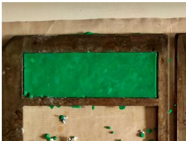
Contracción del PEAD
