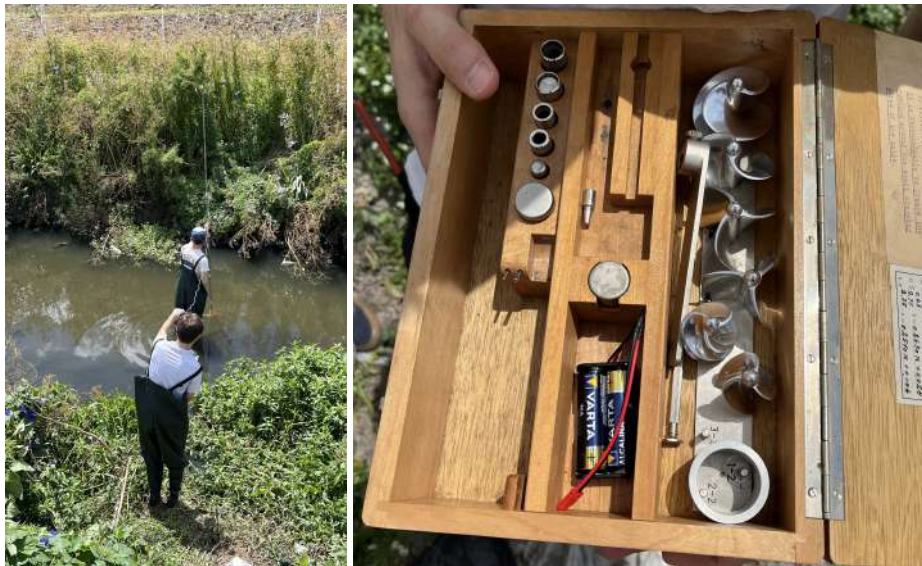
Figura 6.8: Procedimiento de medida con correntómetro.
