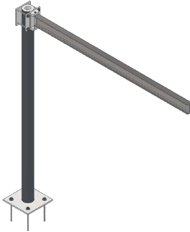
Figura 7.14: Modelo tridimensional de la grúa de recolección.
