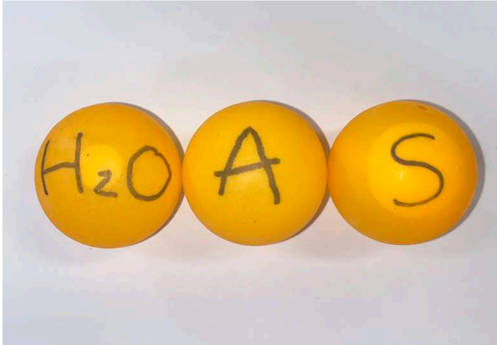
Figura 5.17: Sólidos esféricos de distinta densidad. Se tienen tres fluidos de relleno: agua ( H_2O ), aire (A) y salmuera (S).
