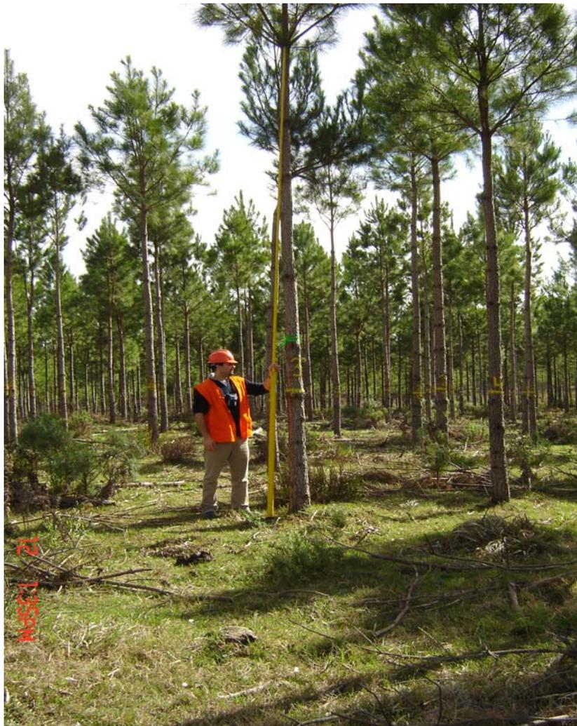
En la medición de las dos variables restantes, *DDFG* ó *DDRV* y *DMSM*, se utilizó cinta diamétrica y escalera extensible de aluminio.
