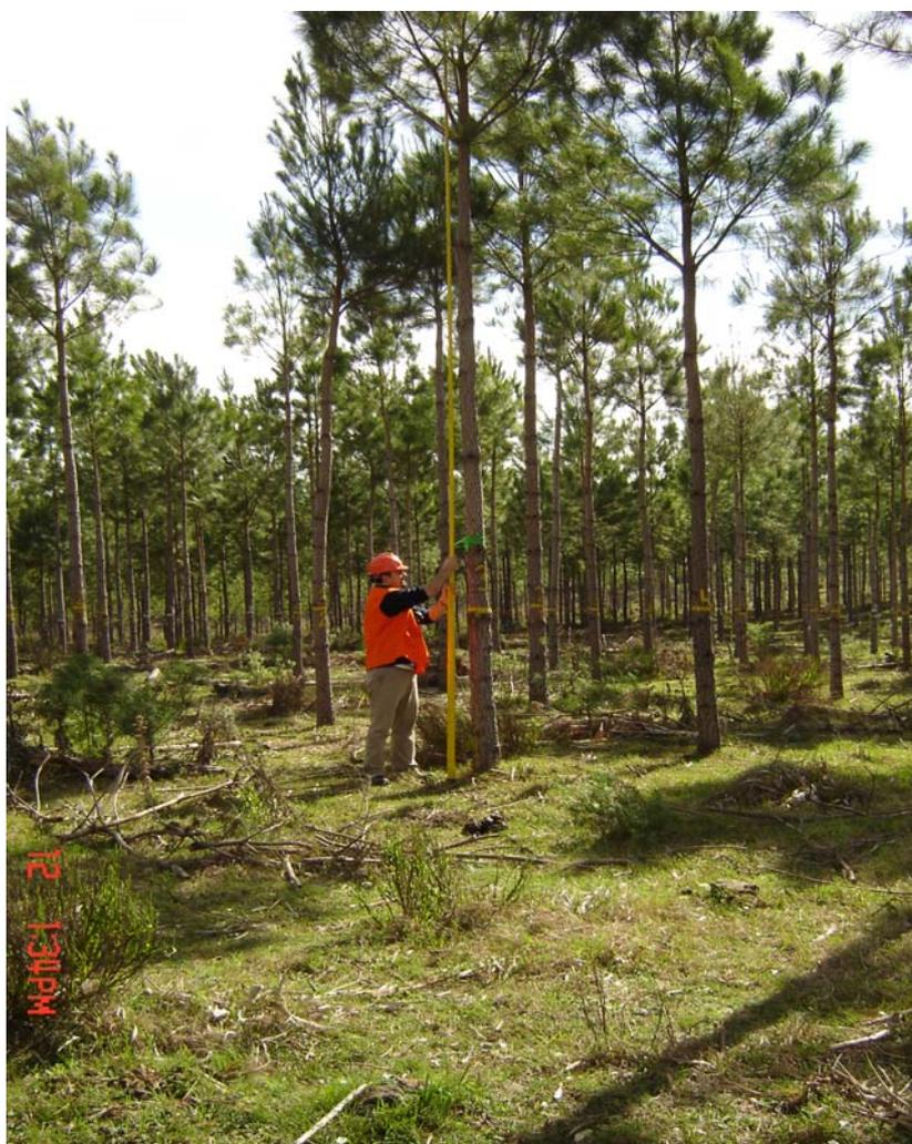
Figura 8. Medición de altura de poda (*HFG*) con la pértiga.
