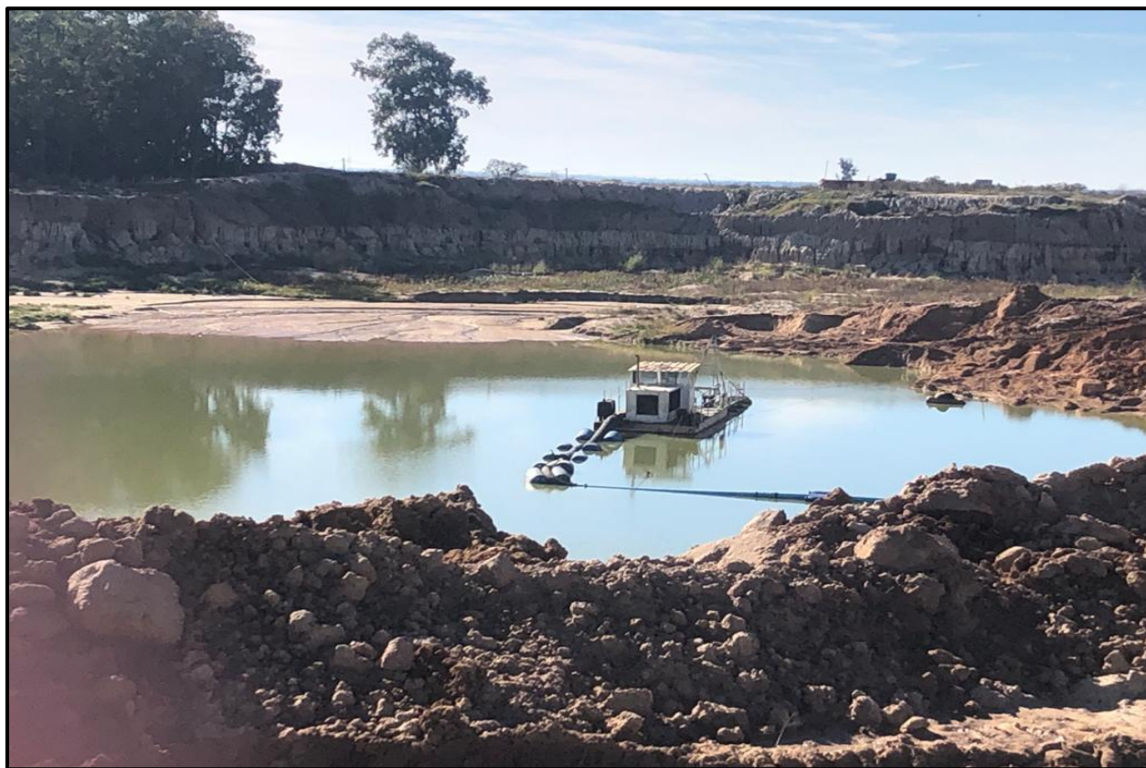
Figura 15. Bomba balsa dentro del lago de extracción de arena.
