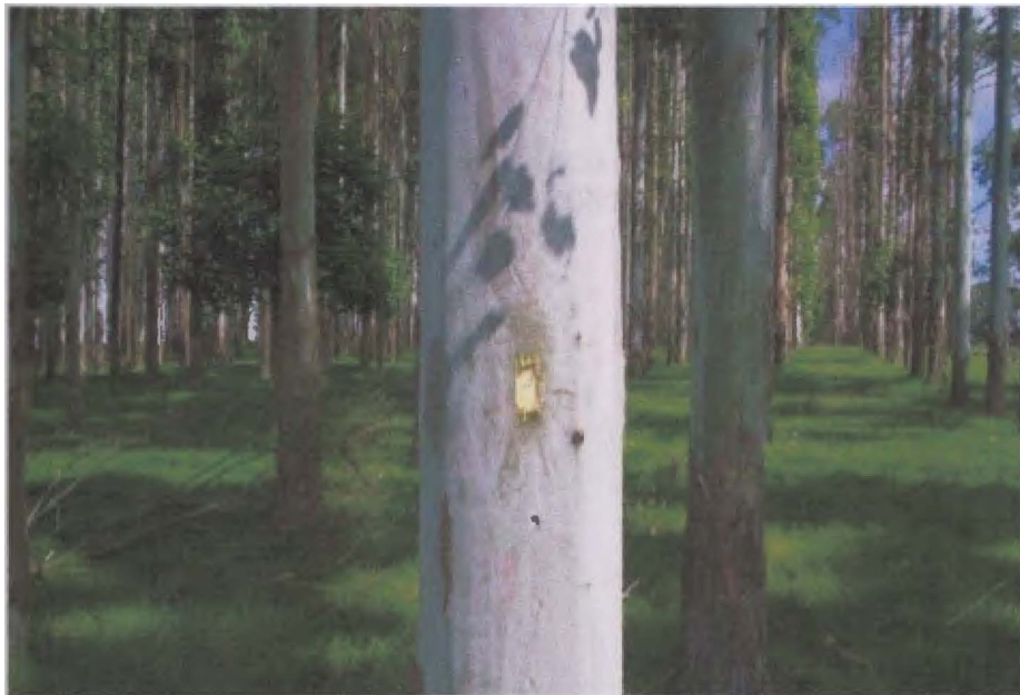
Figura N° 3. Vista de un individuo de la prueba de progenies con la perforación en la corteza para la toma de datos de Pilodyn
