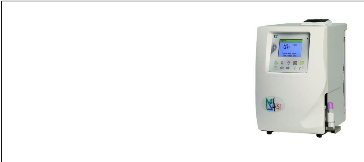
**Figura N° 2: Contador automatizado para hematología.**
