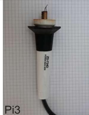
La pieza de madera es torneada y ahuecada para que se le pueda introducir el sistema de calentamiento. A esto se le acopla el cable eléctrico y luego se monta la caja en donde va el transformador, el regulador de temperatura, la luz que indica su encendido y el botón de encendido y apagado.
