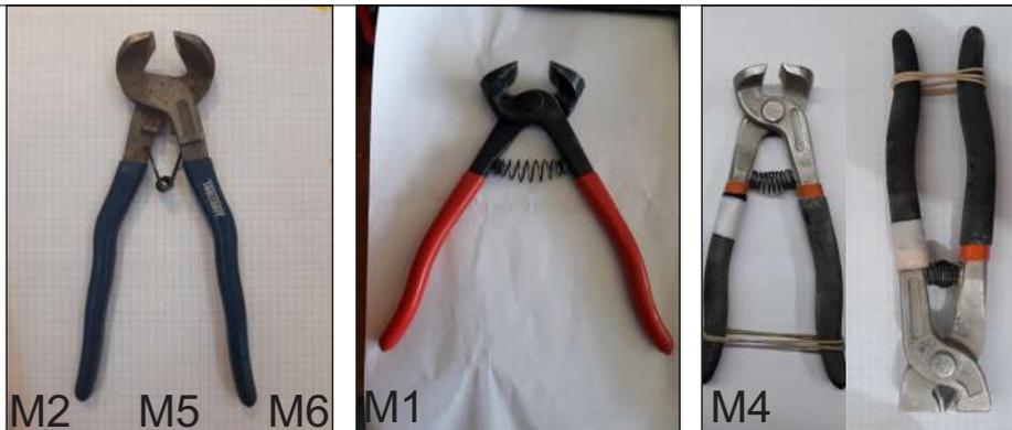
El uso del plástico en la empuñadura de la herramienta es debido a que es un material liviano y fácil de moldear con el que se puede recubrir superficies.
