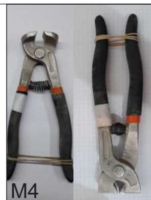
Se detecta el uso de un material blando recubriendo un material duro que prioriza la comodidad del usuario.
