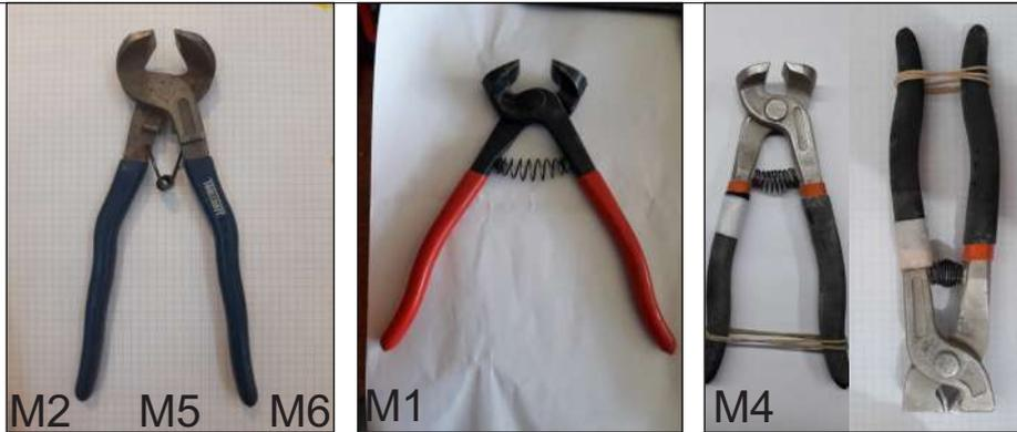
Se pueden identificar tres partes: el área de corte, la empuñadura dual (que consta de dos piezas unidas por medio de un remachado) y el resorte ubicado entre estas dos (que permite la apertura de las empuñaduras).
