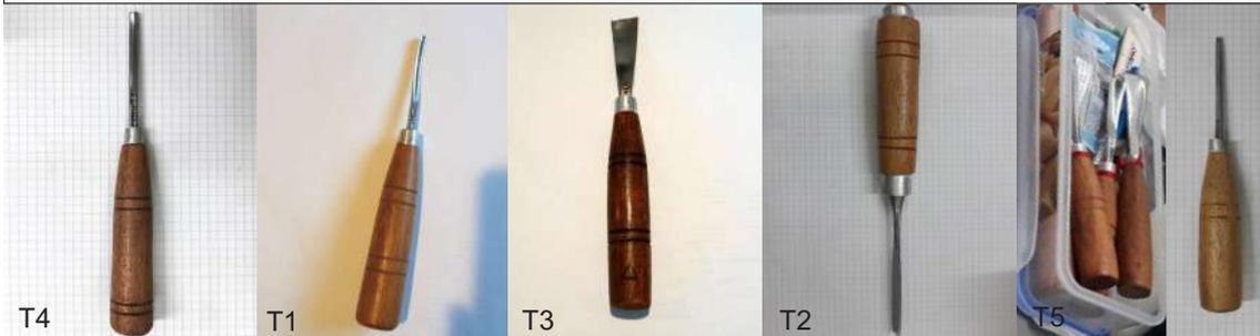
A nivel específico se puede reconocer un volumen cilíndrico que está continuo a un volumen con forma de cono truncado, el mismo está unido por su parte más fina a un cilindro de menor diámetro que el primero. Desde este se extiende un volumen que tiende a deformarse en su extremo debido al tipo de bisel.
