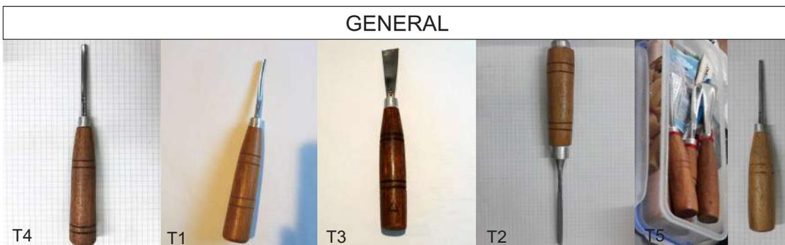
El uso de madera permite generar una empuñadura para el usuario y un soporte firme para el acero, el mismo está encastrado y pegado a la pieza de madera para no generar problemas en su uso.
