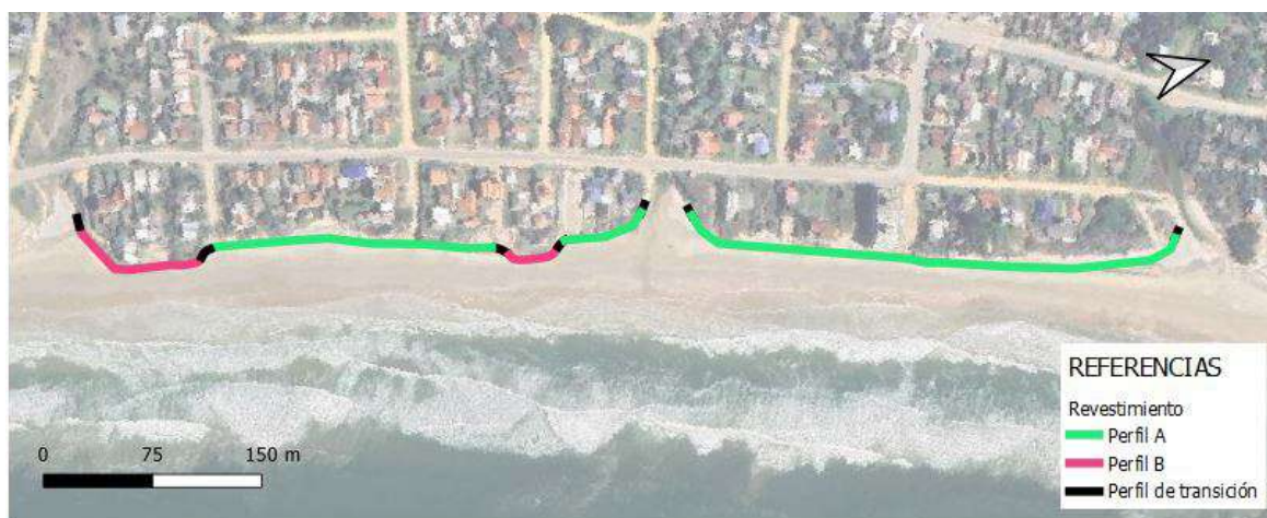
Figura 62: Trazado en planta del revestimiento
