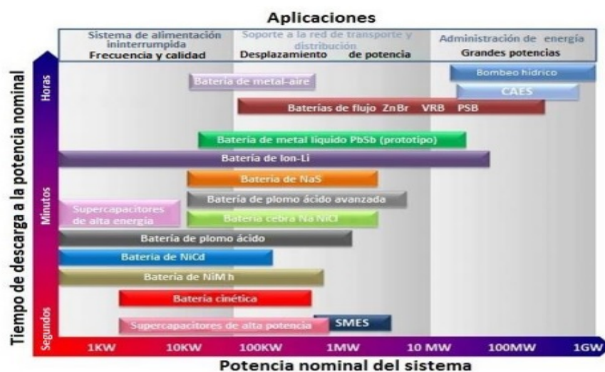
Figura H.1: Tecnologías de almacenamiento [46].
