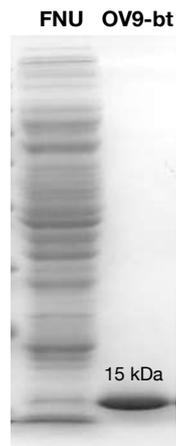
**Figura 4.34.** SDS-PAGE del nanobody OV9 biotinilado purificado por IMAC. FNU: fracción no unida.
