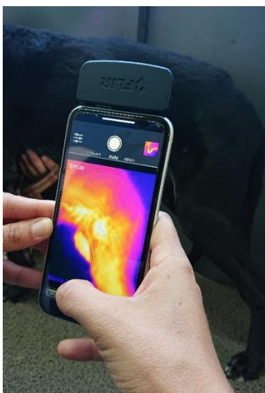
Figura 3: Cámara FLIR One® acoplada al teléfono Iphone® y visualización de la termografía infrarroja.
