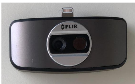
Figura 2: Cámara FLIR One ® donde se aprecia el sensor termográfico y lente fotográfico.
