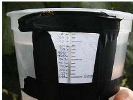
**Foto B:** Muestra como al retirar el racimo el nivel de agua desciende desde el aforo.
