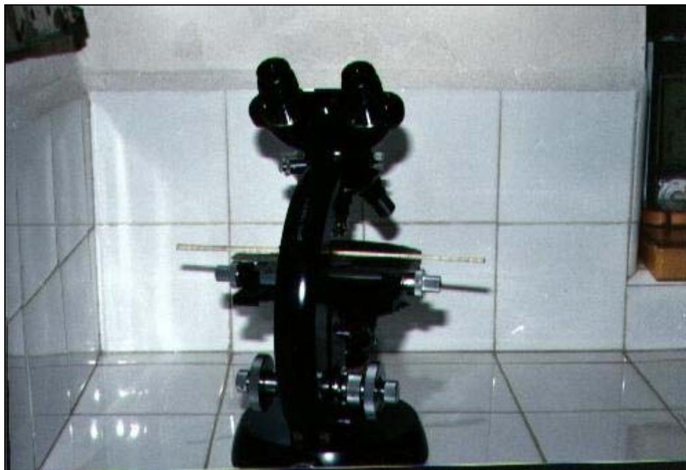
Figura 5. Microscopio OLYMPUS adaptado para medición de incrementos radiales.
