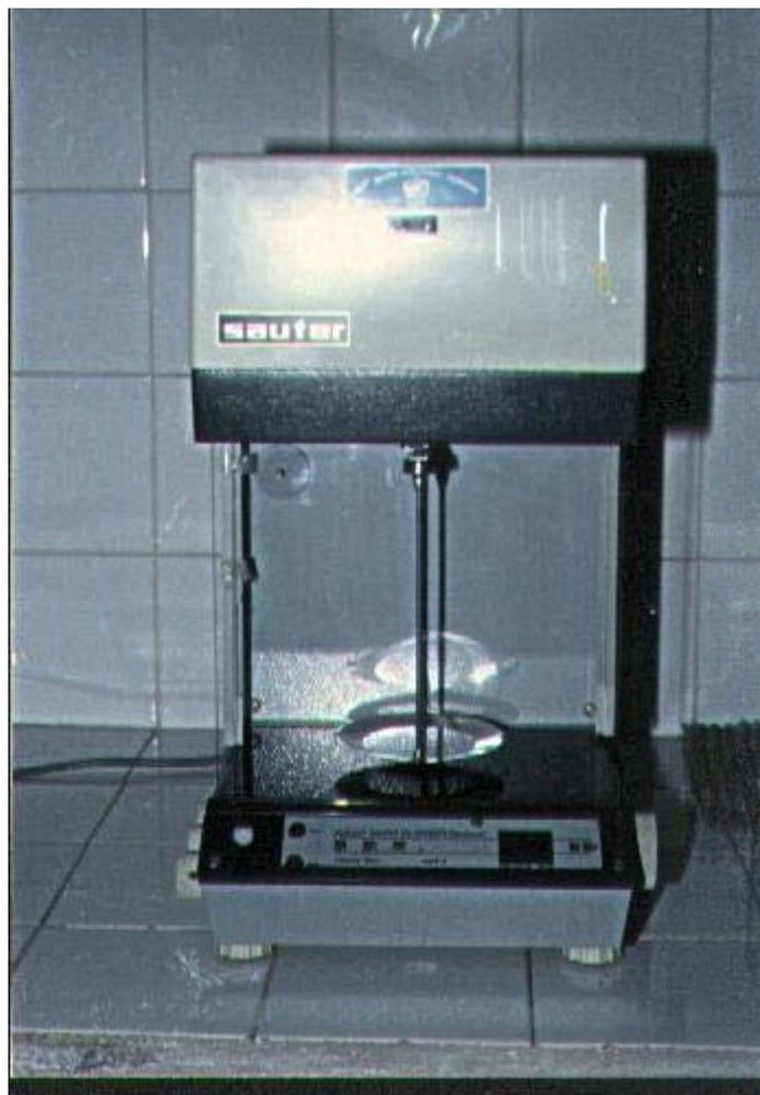
Figura 6. Balanza Sauter utilizada en la medición de peso anhidro y peso saturado de secciones de probeta de incremento radial.
