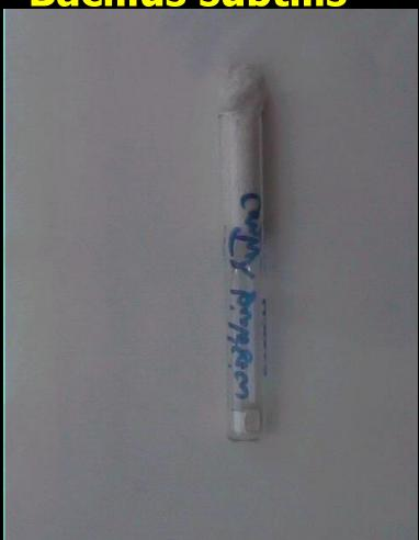
Control biológico de esterilización para horno con medio de cultivo para incubar(37°C)
