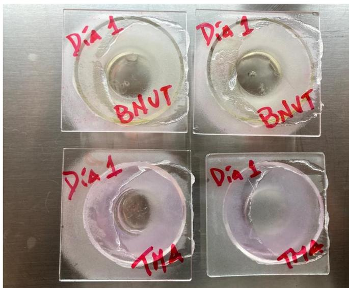
**Figura 4.** Placas de microdifusión de Conway utilizadas para la determinación de bases nitrogenadas volátiles totales y trimetilamina. Gérez y Paiva, 2022
