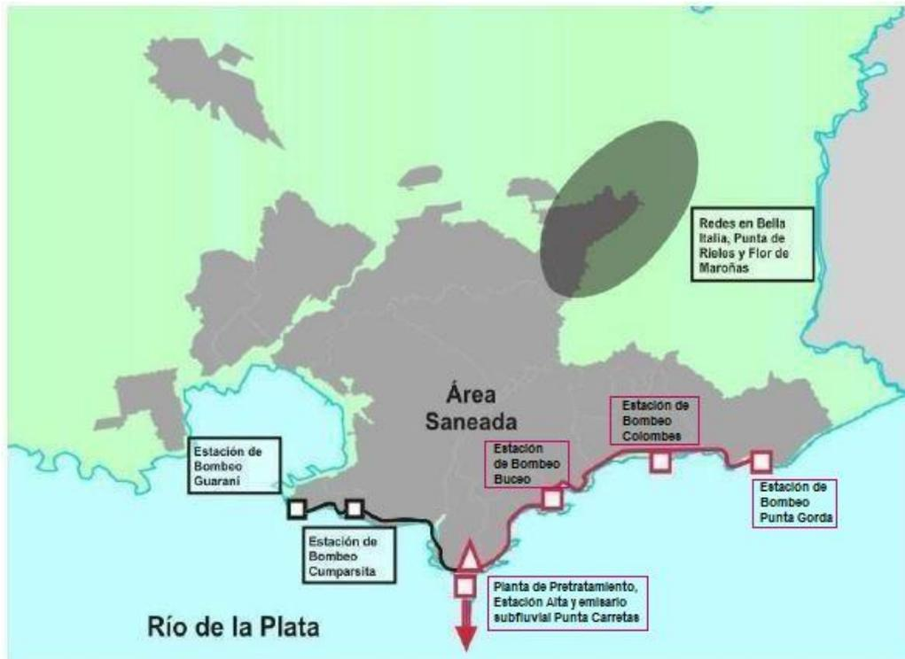
**Figura 3.** Red de colectores del Sistema Costero Este (línea rosa) y del Sistema Paraguay (línea negra).
