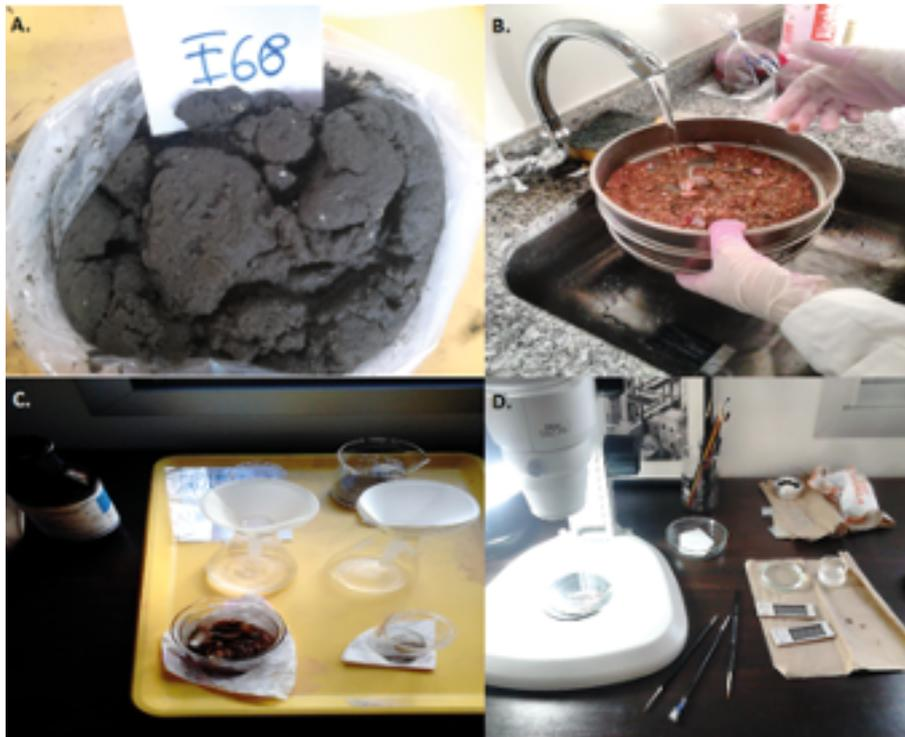
Figura 4. Procesamiento inicial de las muestras. A. Descongelamiento y descripción visual de las muestras de sedimento superficial. B. Tamizado húmedo. C. Tratamiento con Tricloroetileno. D. Observación bajo lupa estereoscópica.
