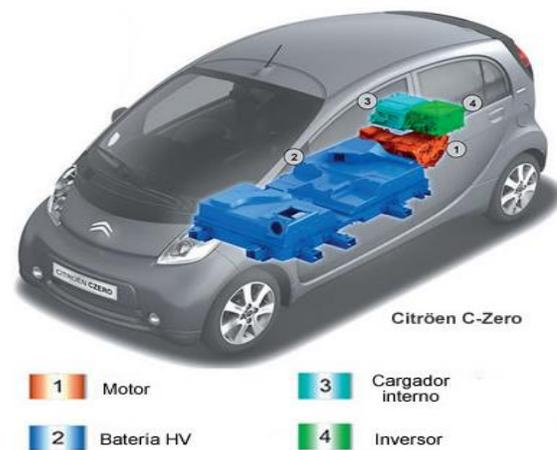
1: Motor eléctrico. 2: Batería de Litio de 1500Vcc. 3: Dispositivo que se conecta a la red eléctrica y carga las baterías del auto. 4: Conversor que transforma la corriente continua de las baterías en corriente alterna para su uso en el motor eléctrico del vehículo.
