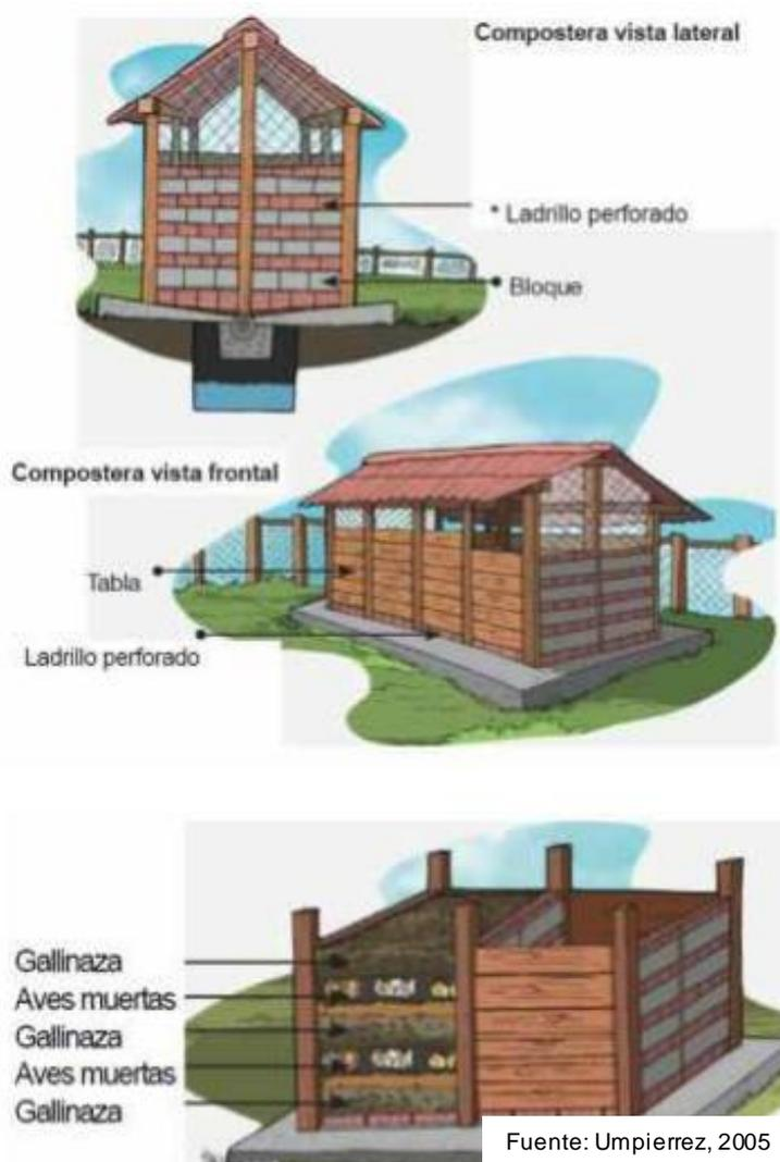
Figura 2 Diagrama de instalaciones de compostaje de cadáveres
