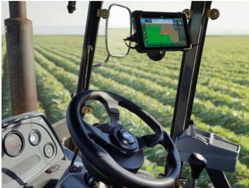
*Ilustración 17: Piloto automático sobre un tractor. Fuente: Google imágenes.*
