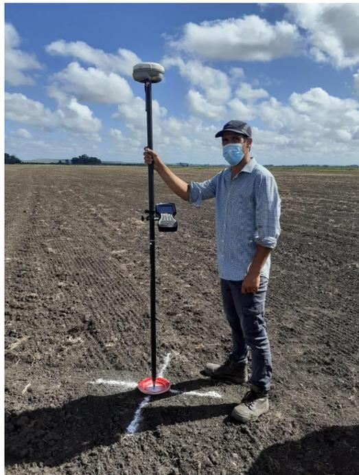
*Ilustración 23: Medición con GNSS de un punto de apoyo. Fuente: Propia*
