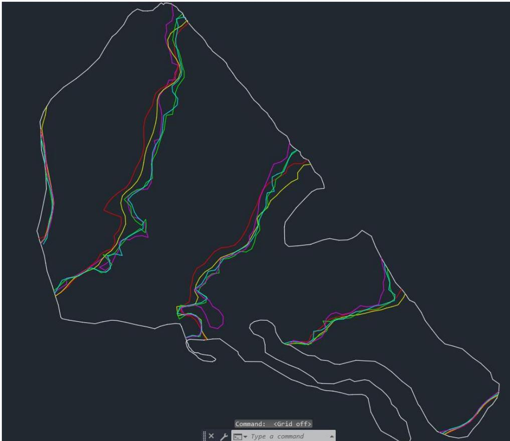
*Ilustración 43: Curvas de nivel cada 5cm generadas en AgroCad. De izquierda a derecha elevaciones de 30.75, 30.50, 30.25 y 29.75. Rojo: Agisoft Disp1; Amarillo: Agisoft Disp2; Verde: Pix4D Disp1; Celeste: Pix4D Disp2; Blanco: GNSS; Azul: Nivel Óptico. Fuente: AutoCad Civil 3D.*
