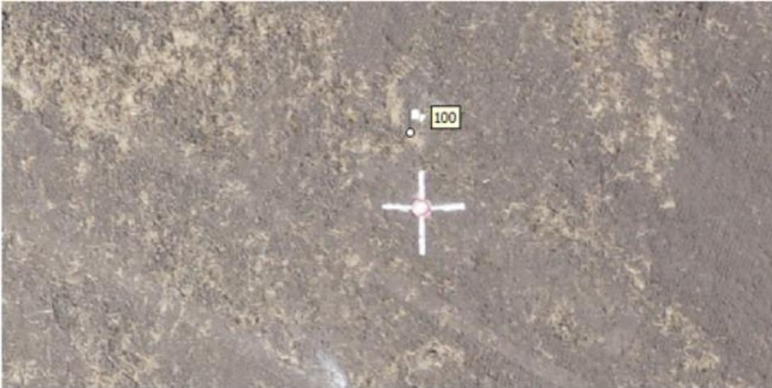
*Ilustración: Punto de apoyo y materialización de campo del punto de apoyo. Como se observa, el punto de apoyo numero 100 debe corregirse a la posición de la cruz marcada. Fuente: Agisoft Metashape.*
