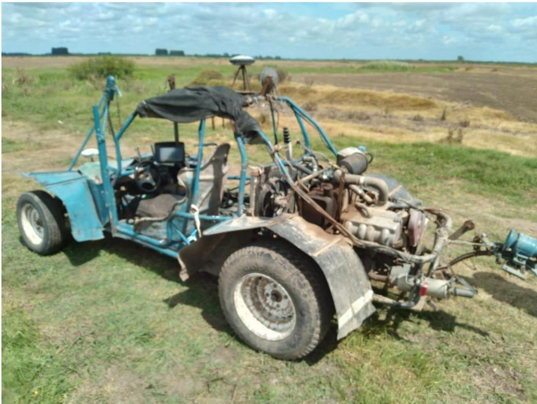
*Ilustración 27: Vehículo que recorre el campo midiendo el terreno con el GNSS móvil. En él se ve una pantalla (banderillero) que funciona como guía para hacer las pasadas en el campo. Fuente: Propia.*
