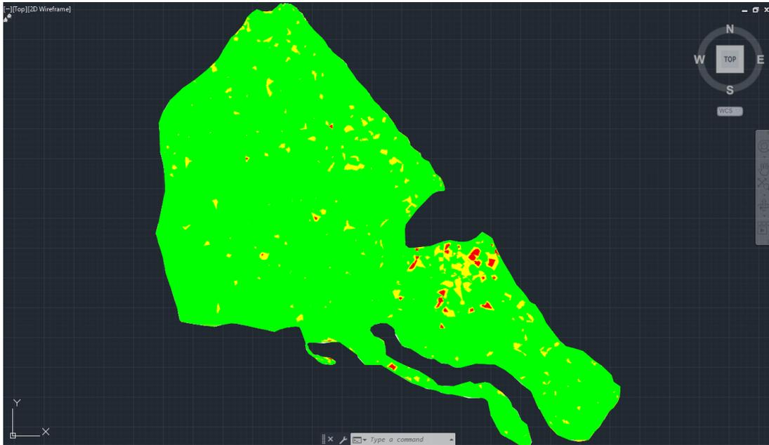
*Ilustración 52: Mapa de la zona de estudio coloreado según la diferencia de nivel entre el procesamiento con distribución 1 en Pix 4D y el GNSS. En verde las diferencias van de 0cm-5cm; amarillo de 5cm-10cm y rojo mayor a 10cm. Fuente: AutoCad Civil 3D.*
