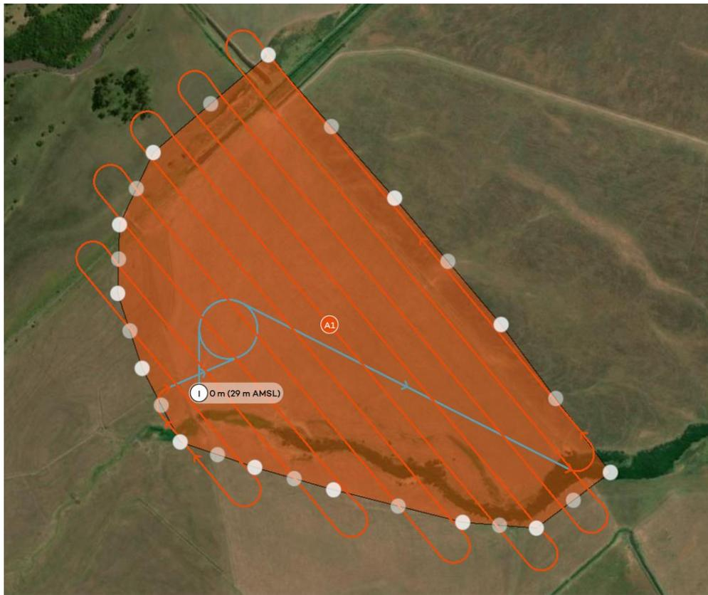
*Ilustración 26: Plan de vuelo a 200m. En naranja las líneas de vuelo, el punto "I" es el punto de despegue y de aterrizaje, en celeste es la transición que hace el UAV en el despegue y aterrizaje. Fuente: WingtraHub.*
