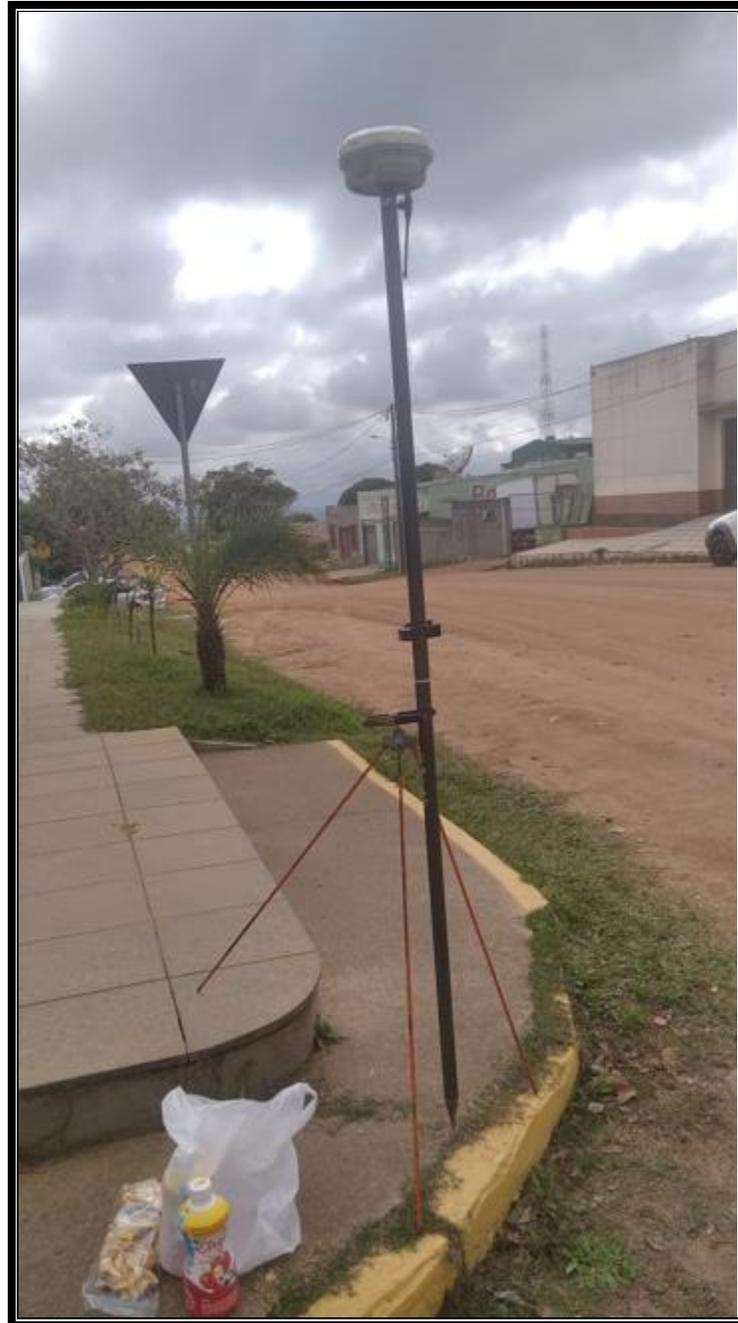
*Imagen 31- Rover gravando datos en estación Excéntrica cerca del punto 1953E*
