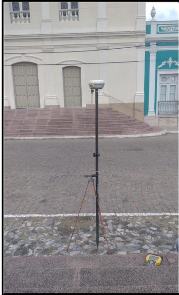
*Imagen 28 – Rover Grabando datos en estación Excéntrica cerca del punto 1955U*
