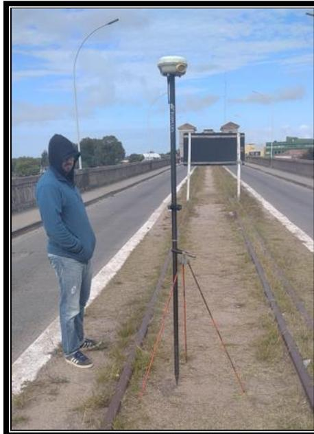
*Imagen 25 – Rover grabando datos en la estación Excéntrica cerca punto 1955T*
