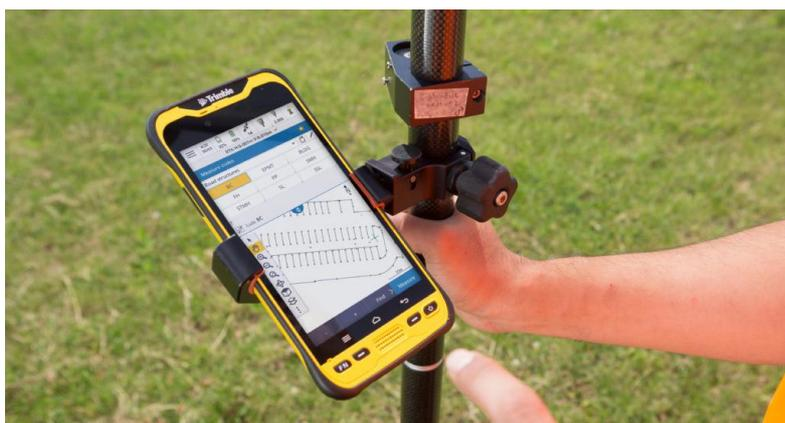
Figura 3.3.22 - Controladora GNSS utilizada
