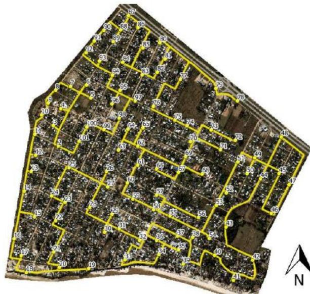
Figura 1.3.2 - Caminamiento y Distribución de los Puntos GNSS relevados.
