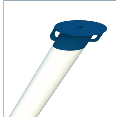
En la parte superior de cada brazo se encuentra identificado el anclaje para el aerogenerador y por debajo se encuentran identificados los anclajes para las lingas.
