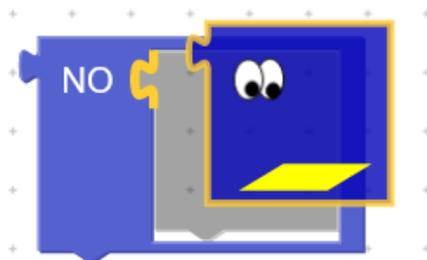
Figura 6.3: Diferencias entre los conectores del bloque y su marcador de inserción
