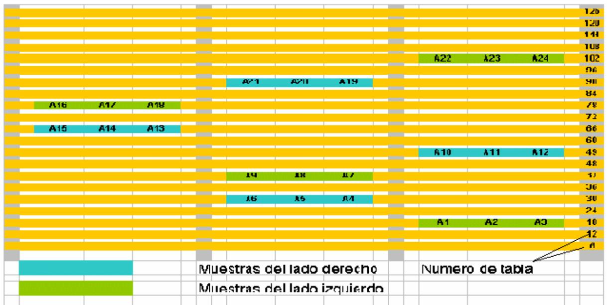
**Figura 4.** Castillo de madera, vista lateral, con el detalle de la ubicación de las muestras y numeración de las tablas.
