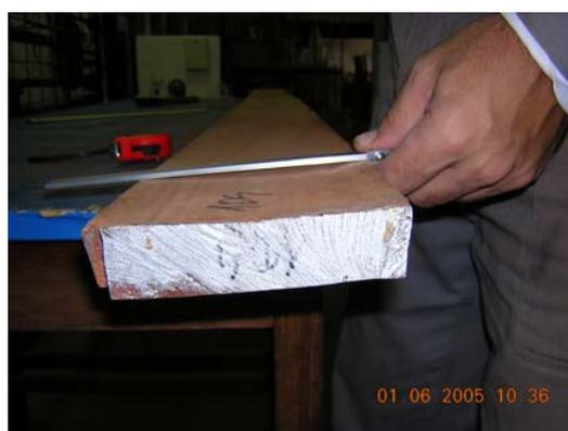
**Figura 10:** Foto de medición de abarquillado
