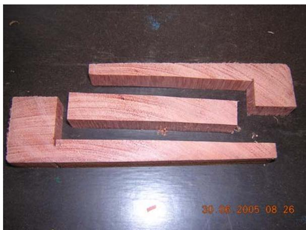
**Figura 7:** Foto de probetas de gradiente de humedad
