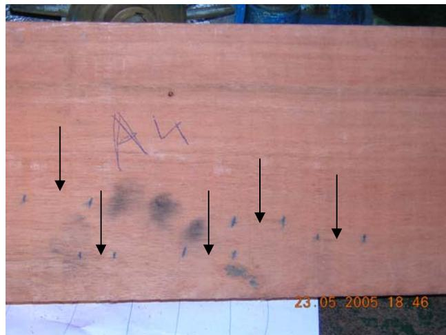
**Figura 17:** Foto de grietas superficiales cerradas después del vaporizado
