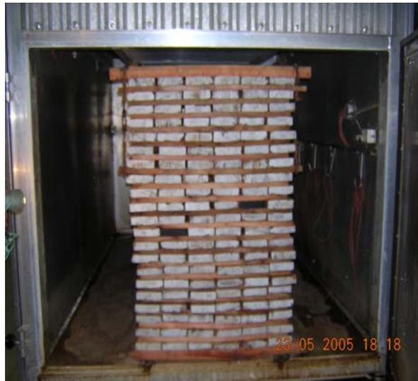
**Figura 5:** Foto del castillo dentro del horno de secado
