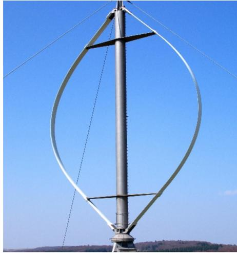
Figura 2: Fotografía de aerogenerador tipo Darrieus.
