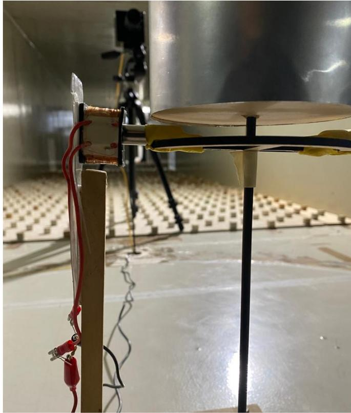
Figura 90: Fotografía del generador lineal.
