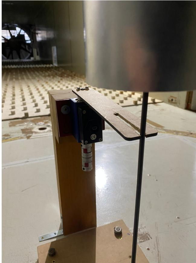
Figura 68: Fotografía del dispositivo elaborado para determinar la potencia a extraer del aerogenerador por vorticidad.
