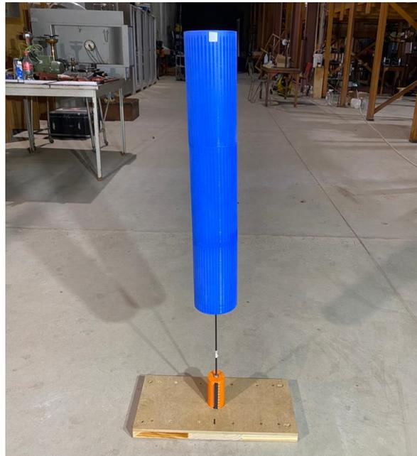
Figura 81: Modelo con mástil construido en PLA
