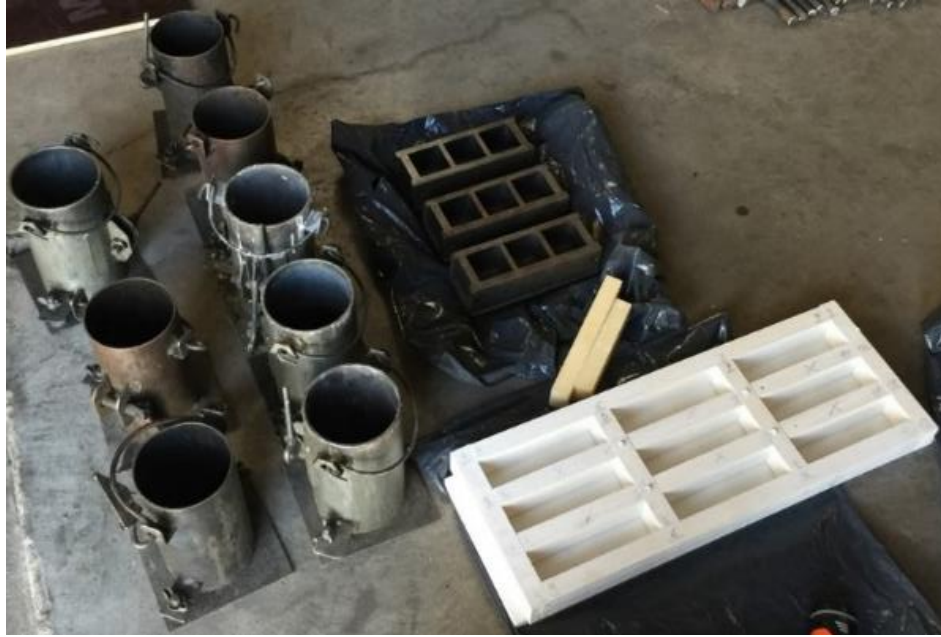
Figura 3.6 – Moldes empleados para realización de probetas. (Fuente: elaboración propia en base a imágenes capturadas)
