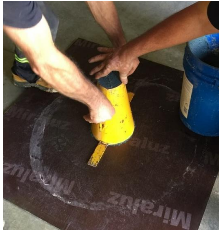
Figura 3.8- Ensayo escurrimiento con cono de Abrams. (Fuente: elaboración propia en base a imágenes capturadas)
