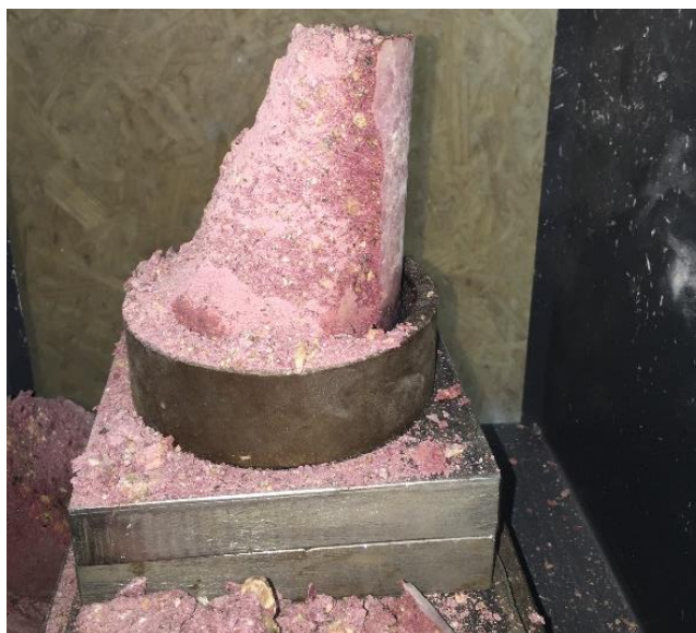
Figura 3.12 – Rotura de probeta cilíndrica HACC rojo (Fuente: elaboración propia en base a imágenes capturadas)
