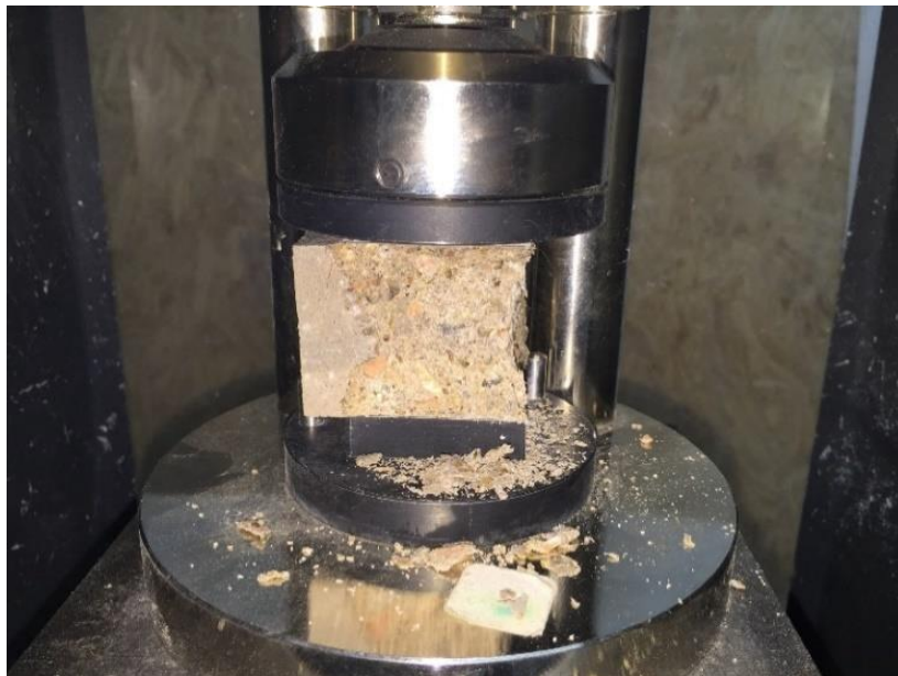
Figura 3.14 – Ensayo a compresión de mitad de probeta prismática (Fuente: elaboración propia en base a imágenes capturadas)
