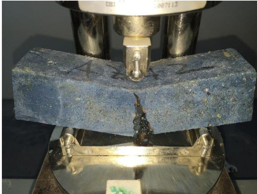
Figura 3.13 – Ensayo a flexión de probeta prismática. (Fuente: elaboración propia en base a imágenes capturadas)
