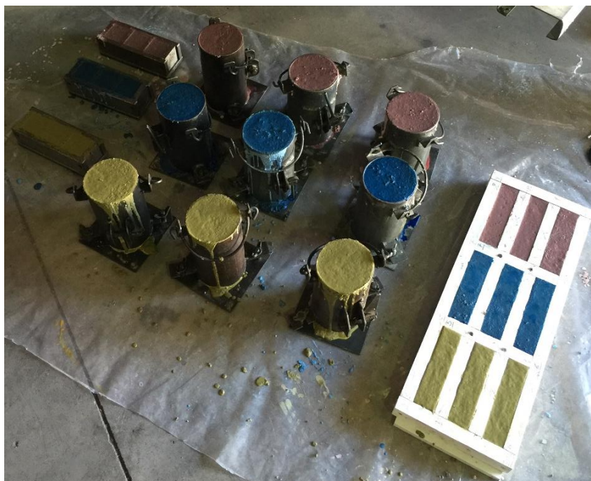
Figura 3.11 – Moldes empleados para los ensayos en estado endurecido. (Fuente: elaboración propia en base a imágenes capturadas)
