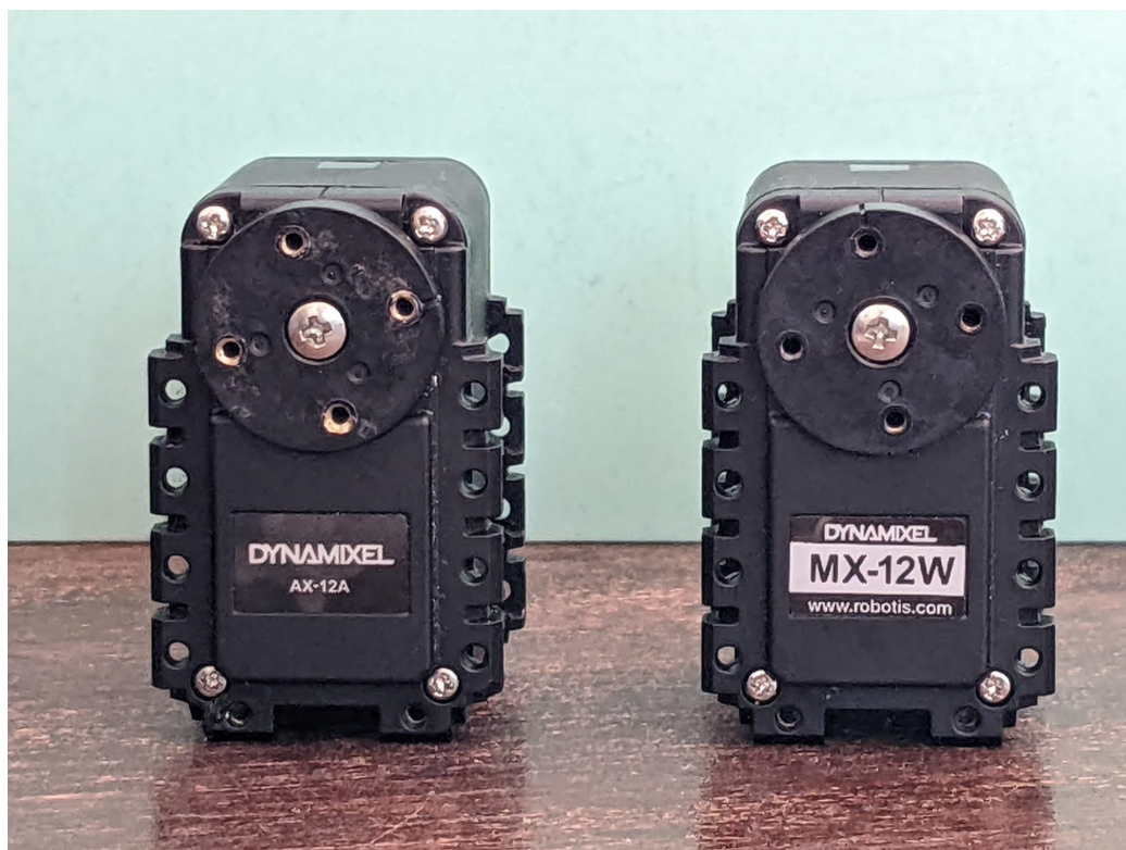
Figura 2.2: Foto de un motor modelo AX (izquierda) y otro MX (derecha).
