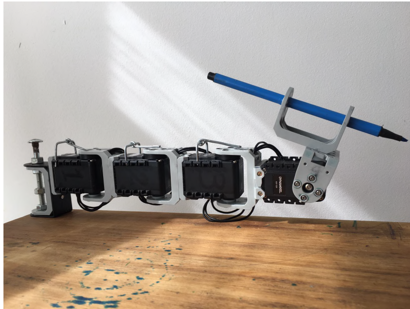
Figura 2.11: Forma del brazo realizado por el equipo PicassoBot.
