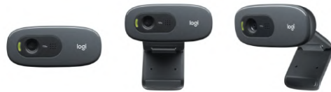
Figura 2.23: Cámara web Logitech C270 utilizada para la adquisición de fotos en tiempo real.
