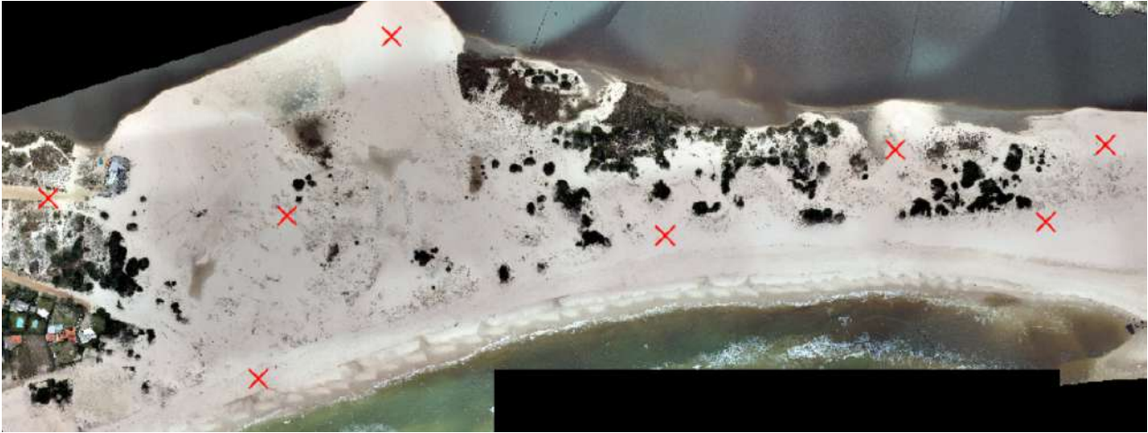
Fig 20. Distribución de puntos de apoyo sobre zona de estudio. Fuente: elaboración propia.
