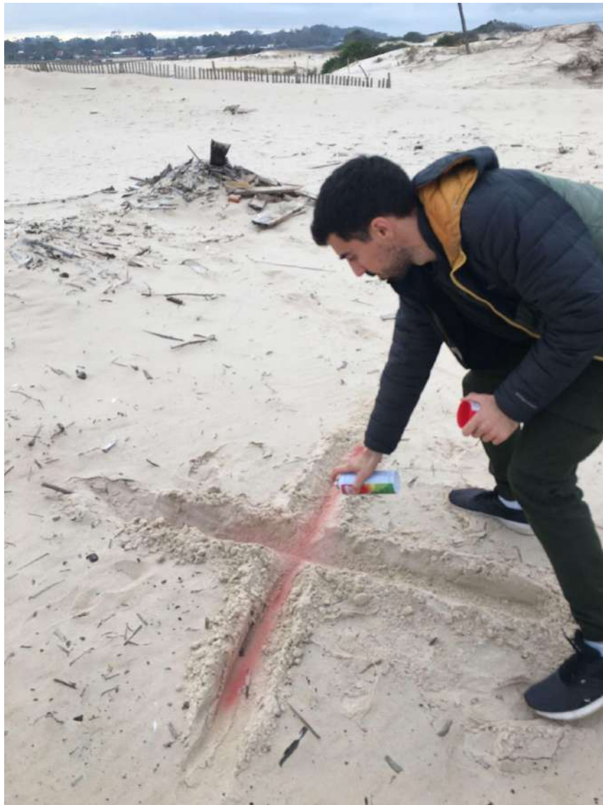
Fig 17. Construcción de los Puntos de Apoyo. Fuente: elaboración propia.
